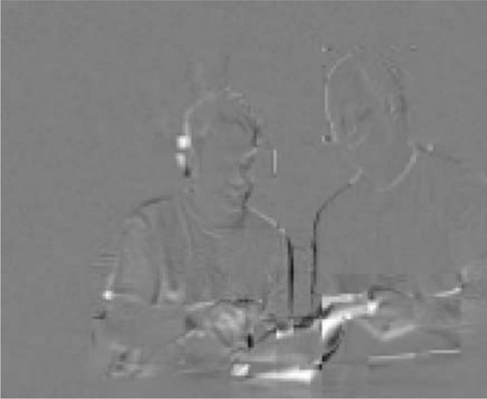
FIGURE 1.10 – Résidus avec compensation de mouvement
