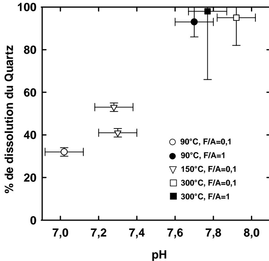
Figure IV-35 : Taux de dissolution du quartz en fonction du pH des solutions mesuré à 25°C après réaction.
