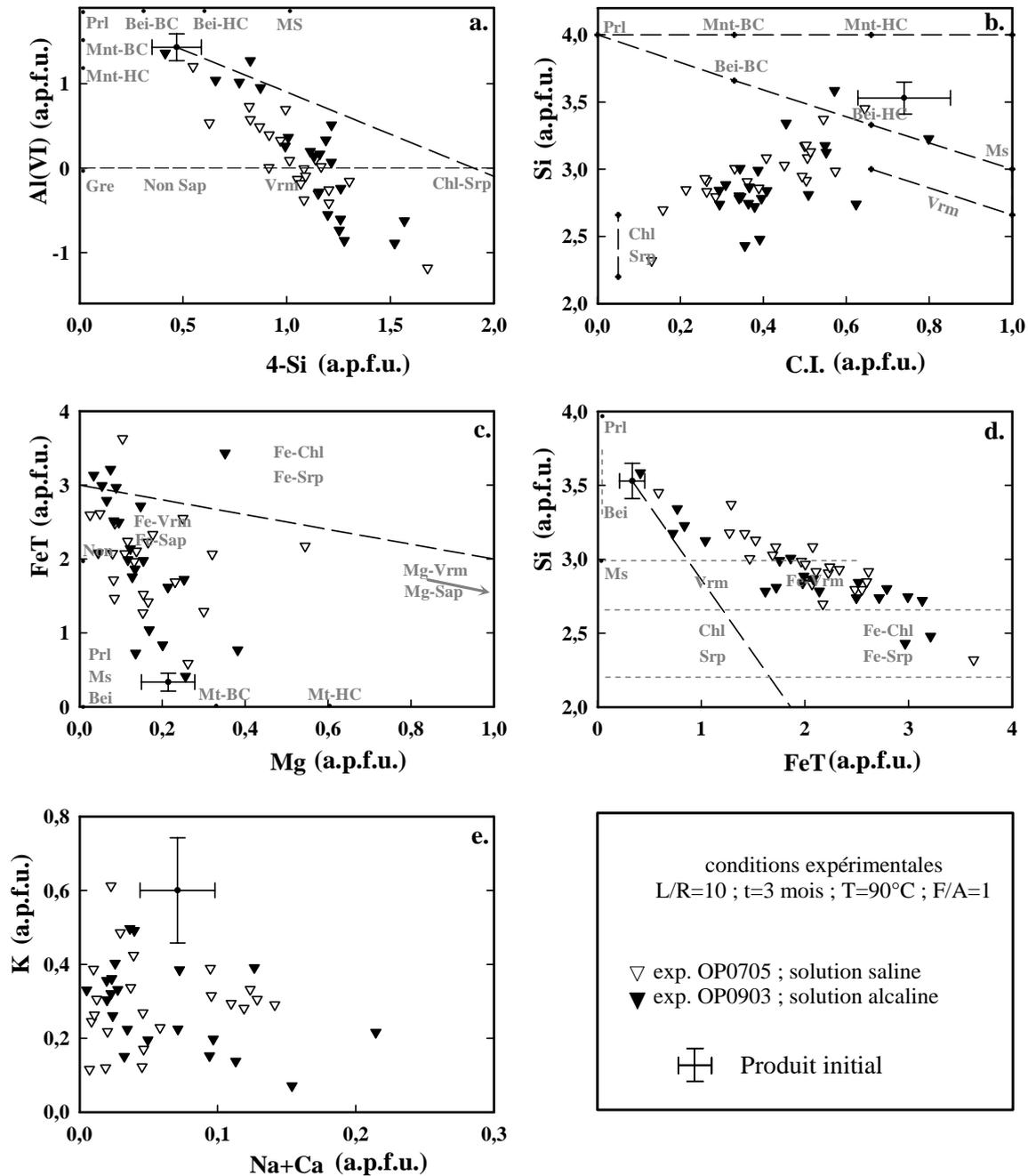
Figure V-7 : Variations cristalchimiques des particules argileuses de l'argilite de départ (EST 26457) et de l'argilite traitée à 3 mois à 90°C en présence d'une solution (L/R=10) soit saline, soit alcaline et de fer métal en poudre (F/A=1) et en plaque.
