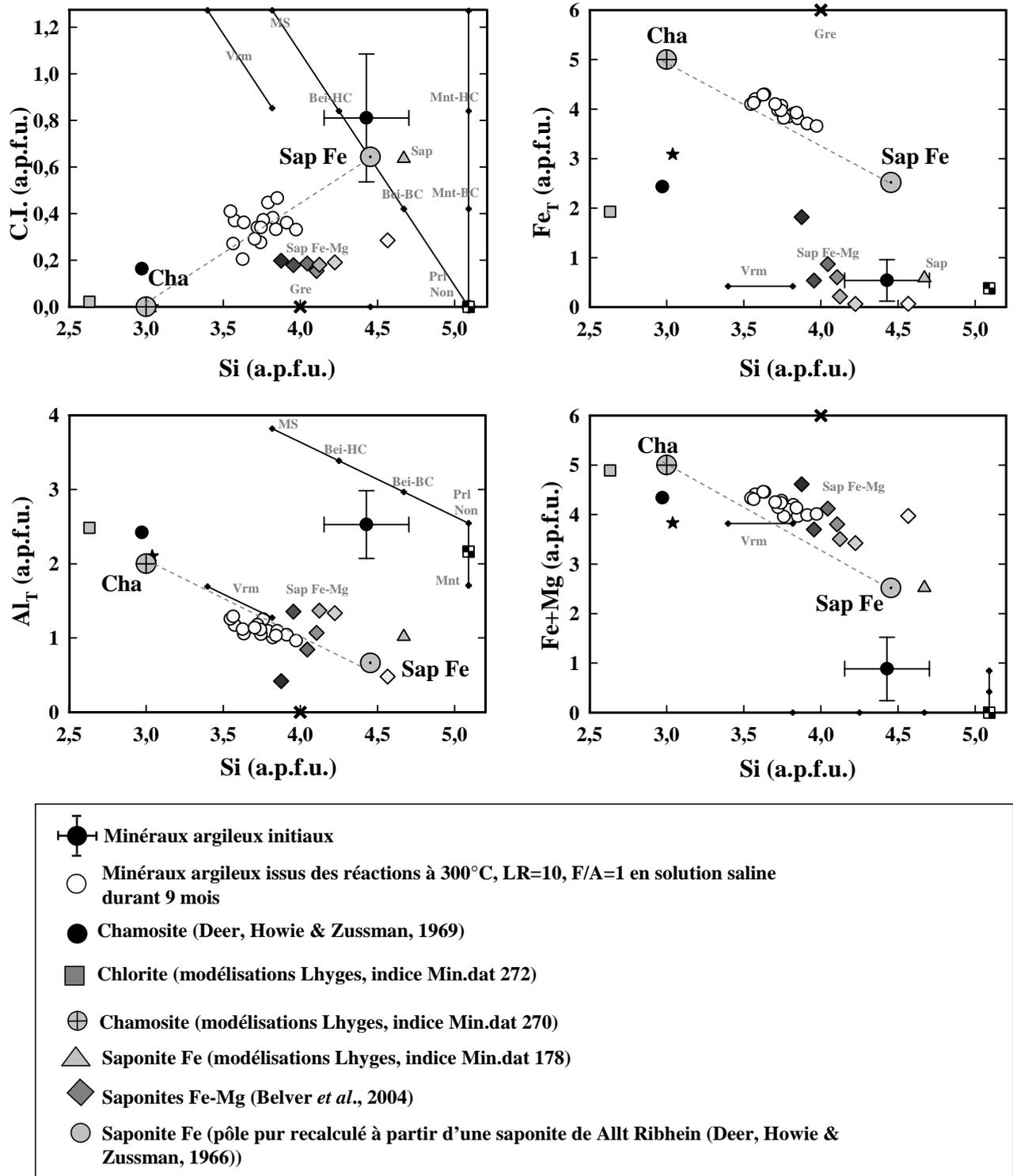
Figure VI-1 : Cristalchimie des produits de réaction des particules argileuses de l'argilite de départ (EST 26457) à 9 mois à 300°C en présence d'une solution (L/R=10) saline et de fer métal en poudre (F/A=1) et en plaque (la croix représente le produit initial). Les formules structurales sont calculées sur 14 O. Le domaine des chamosites est en bleu, le domaine des saponites en jaune.
