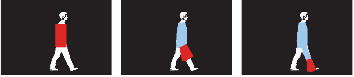
FIGURE 4.3 – Illustration de la décomposition de la fonction d'observation en une séquence d'évaluations locales. La zone bleue représente les pixels communs masqués lors de l'évaluation des précédents segments. Les points de cette zone ne sont pas considérés dans le comptage des points d'intersection N_c , ni dans le calcul de N_s et N_m .
