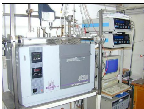
Figure 48 : Montage pour essais électrochimiques dans le verre fondu. (a) vue d'ensemble (b) schéma en coupe.
