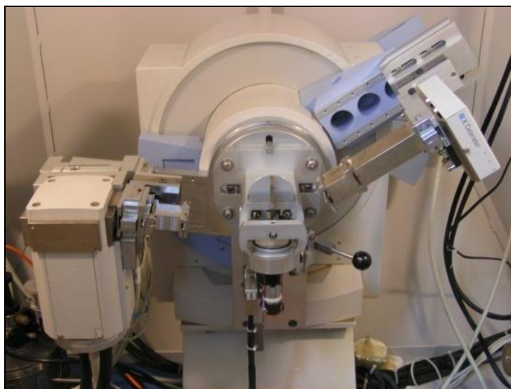
Figure 40: Le diffractomètre X'pert Pro (montage réflexion)
