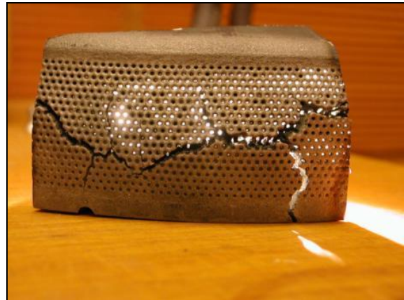
Figure 2 : (a) vue en coupe d'une assiette avant (assiette pleine) et après utilisation (trait noir) et (b) fissuration dans la bande d'une assiette après fonctionnement
