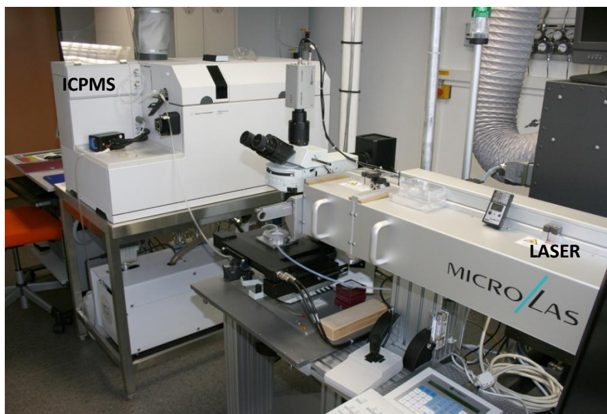
Figure 1: Ablation laser ICP-MS installé dans l'UMR G2R. On distingue le laser d'ablation (MicroLas) le microscope permettant de focaliser le laser et de contrôler le diamètre d'ablation. L'ICP-MS (série 7500, Agilent) est situé au dernier plan.
