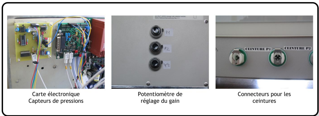
Figure 50 Modification du Maglife™ pour l'acquisition des signaux pneumatiques
