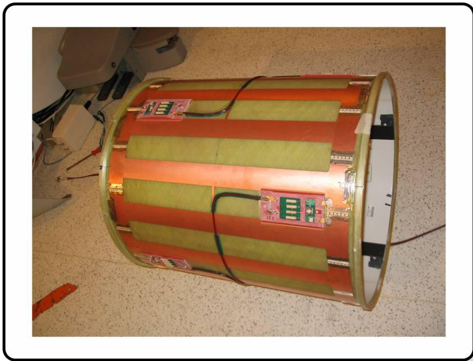
Figure 18 Antenne corps de type cage d'oiseau (Birdcage)
