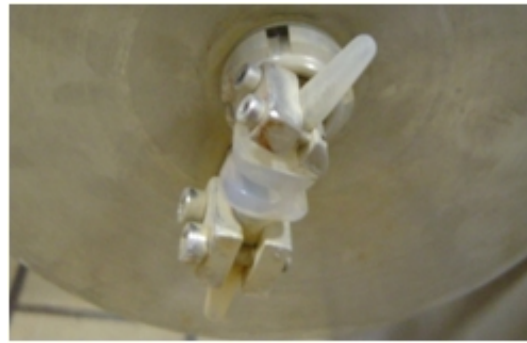
(b) Montage sur la machine de fatigue
