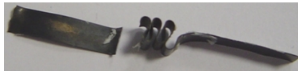
(b) Rupture à l'amorce de la première boucle
