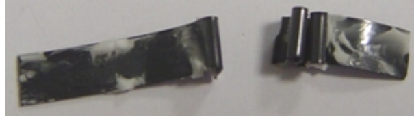
(a) Rupture dans la première boucle
