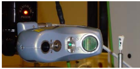
(a) Capteur laser Kréon Zéphir KZ25
