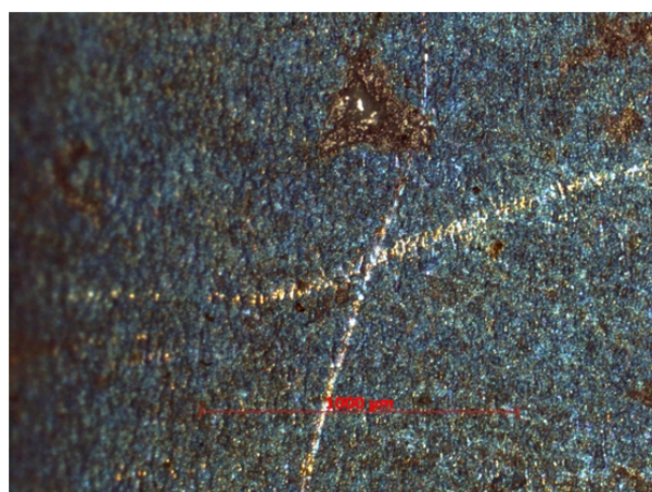
(c) Rayures sur la surface d'une éprouvette non sollicitée
