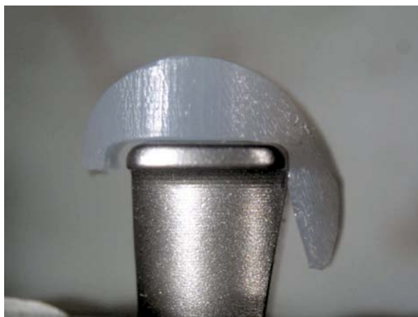
FIGURE 4.15 – Aperçu de la surface proximale S après réalisation de 500 000 cycles de fatigue, mise en évidence d'un léger fluage
