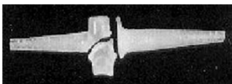
FIGURE 1.21 – Exemple de prothèse Swanson cassée (J.M. Meyer, 2008)
