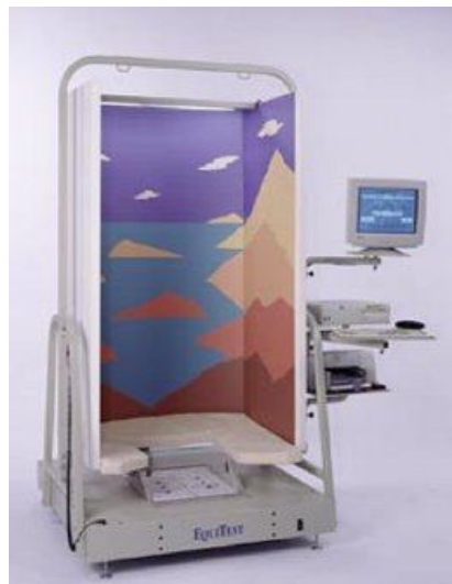
Figure 5 – Cabine de posturographie dynamisée de type EquiTest ® composée d'un panorama et d'une plateforme pouvant être asservis aux oscillations du sujet et d'un ordinateur permettant d'analyser le contrôle postural dans différentes conditions.
