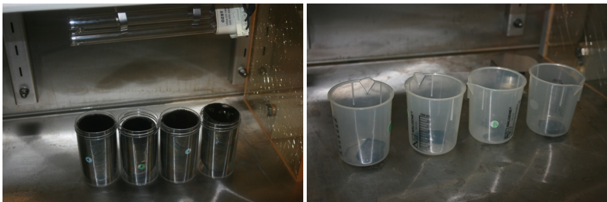
Figure 31 : Boîte à gants divisée en deux parties : à gauche, expériences réalisées en présence d'un rayonnement UVC. A noter : des fractures sont visibles sur les plaques protectrices dues à l'action du rayonnement UVC ; à droite, expériences réalisées sans irradiation UVC.
