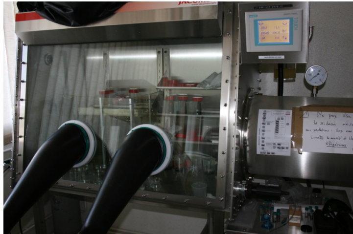
Figure 30 : Boîte à gants GP-Concept type 2 (Jacomex©) d'un volume de 800 L environ.
