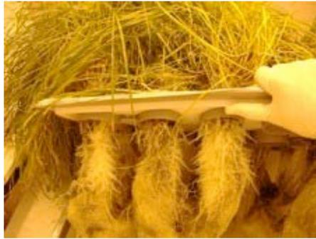
**Figure 9 : Dispositif de culture hydroponique pour la production des exsudats racinaires**
