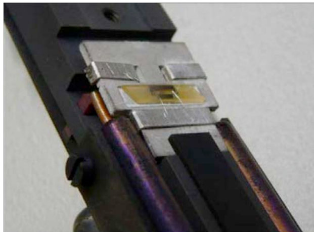
Fig. 3.3 Vue d'ensemble du porte-échantillon utilisé par l'équipe du CTR 10 . Le capot supérieur n'étant pas appliqué, les rubans de platine ne touchent pas l'âme en cuivre des câbles coaxiaux.
