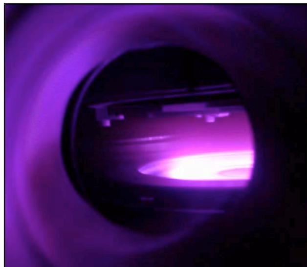
Fig. 4.5 Photographie d'un plasma obtenu à l'aide d'une cathode magnétron. La forme annulaire du plasma est nettement visible
