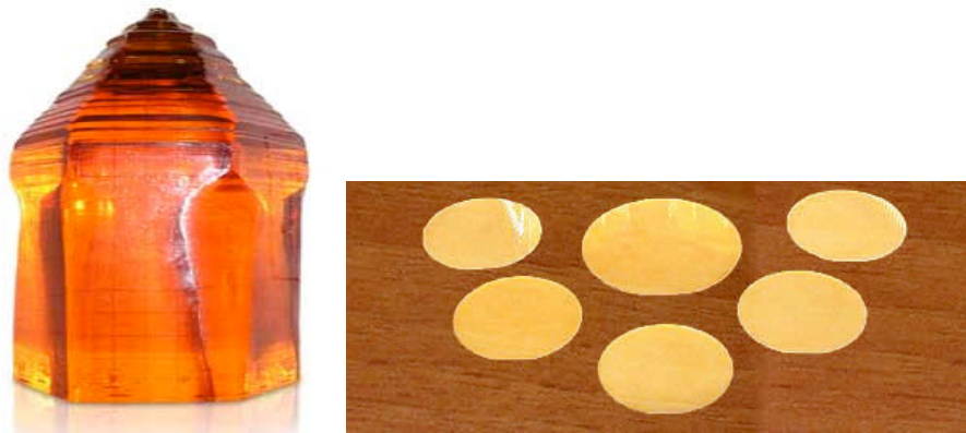
Fig. 1.10 Cristal massif (à gauche) et wafers (à droite) de langasite ( http://www.newpiezo.com )
