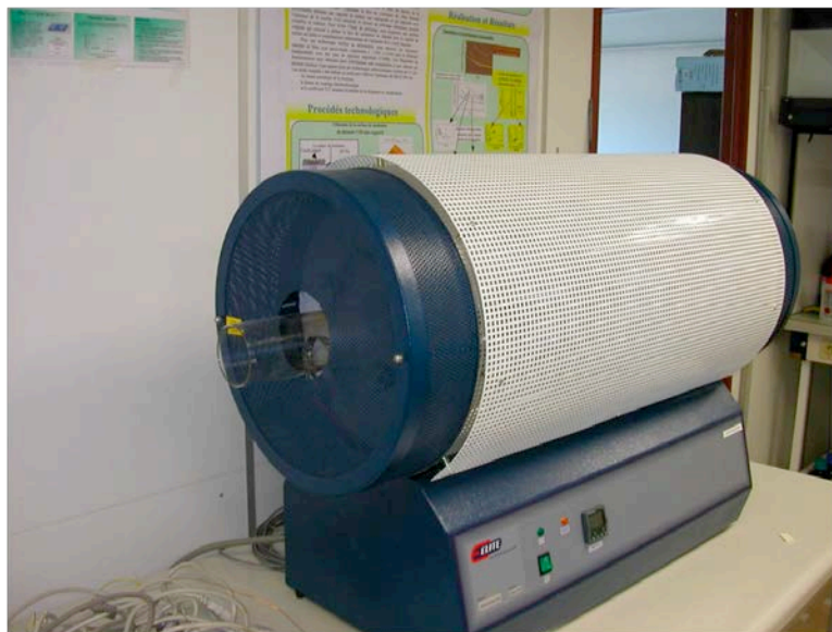
Fig. 3.7 Four tubulaire utilisé au laboratoire pour les recuits et les caractérisations in situ , à haute température, des dispositifs SAW.
