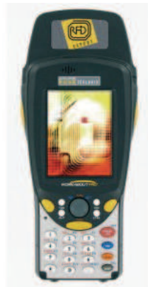
Figure 4.10 : Le PDA industriel WORKABOUT PRO S avec lecteur RFID intégré
