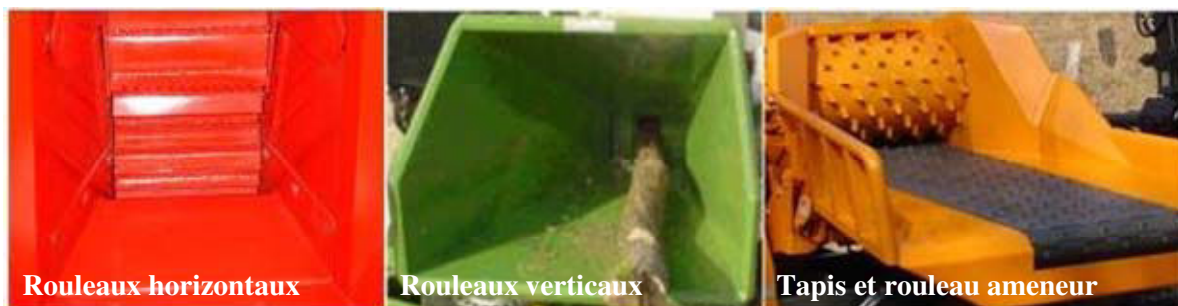
Figure IV-4. Dispositifs d'introduction du bois (source : FARMI Forest, Pezzolato, Norematt)
