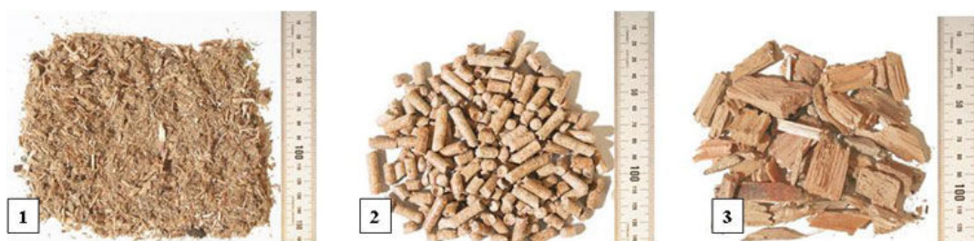
Figure II-8. Différentes formes de combustible bois : sciures (1), Plaquette (2) et granulées (3) de bois (source: biomass-concept.com)
