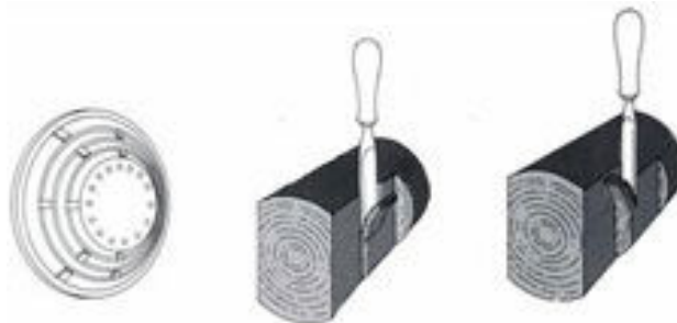
Figure B- 3. Canter à disposition étagée des couteaux et les actions de couteaux [CTBA 2001]
