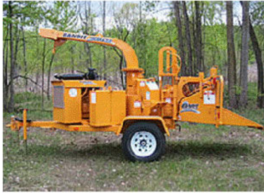
Figure IV-2. Déchiqueteuse de branche actionnée par son propre moteur (source : Bandit)
