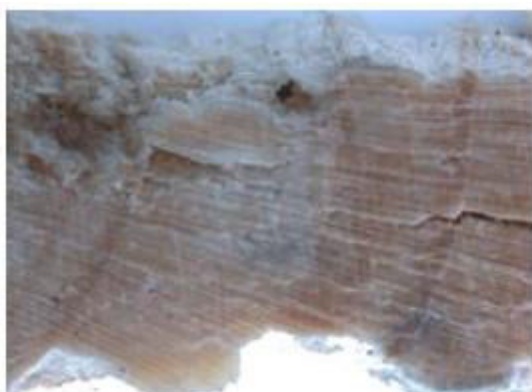
Figure V-42. Plaquette type 2 ; épicéa à gauche et chêne à droite
