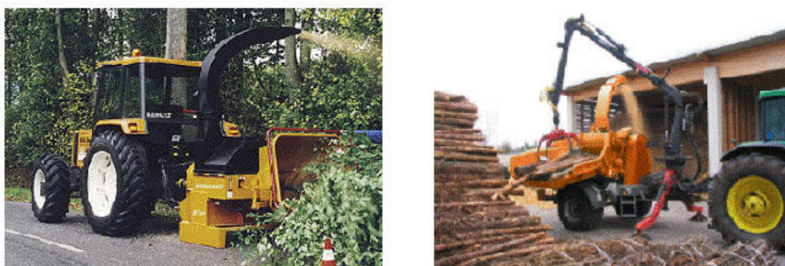
Figure IV-1. Déchiqueteuse actionnée par la prise de force d'un tracteur (source : Noremat)
