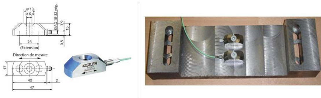
Figure VI-15. Fixation des extensomètres sur le contre couteau
