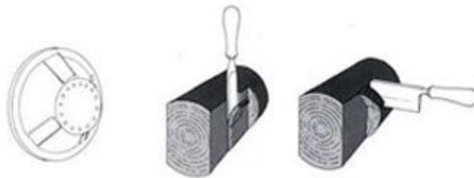
Figure B- 5. Canter à disposition radial des copeaux avec leurs actions sur la grume [CTBA 2001]
