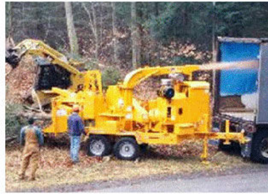
Figure IV-2. Déchiqueteuse de branche actionnée par son propre moteur (source : Bandit)
