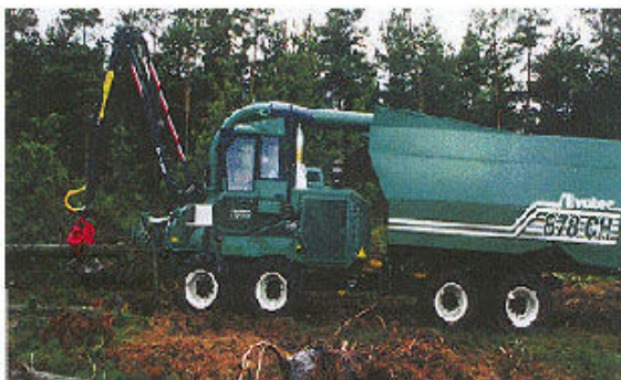
Figure IV-3. Déchiqueteuses de forte capacité (source : Silvatec, Jenz)
