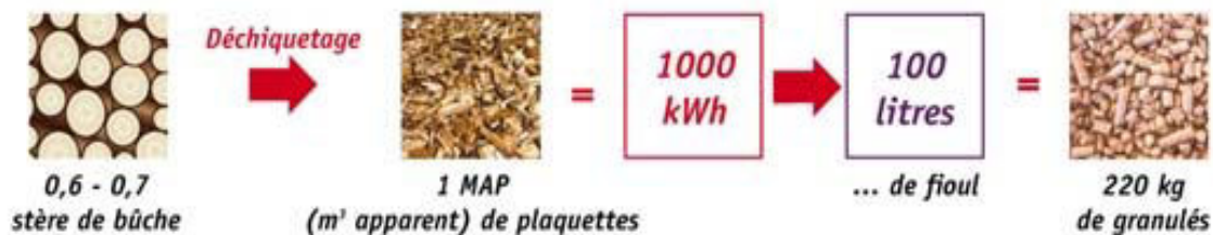
Figure II-4: Equivalence énergétique des différents types de combustible bois
