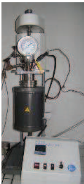
Figure 49. Réacteur Parr (4842) sous pression
