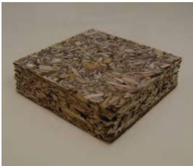
Figure 43. Photographie d'un panneau de particules préparé avec une colle à base de lignine organosolv de MxG
