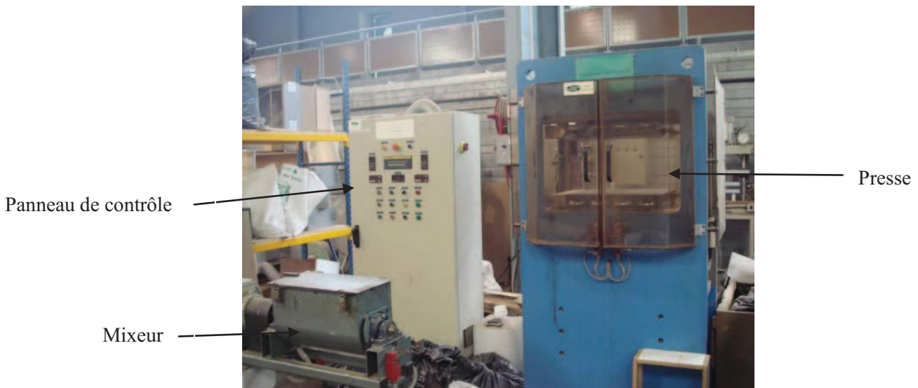
Figure 51. Système de mélangeage et de pressage pour l'élaboration de panneaux de particules
