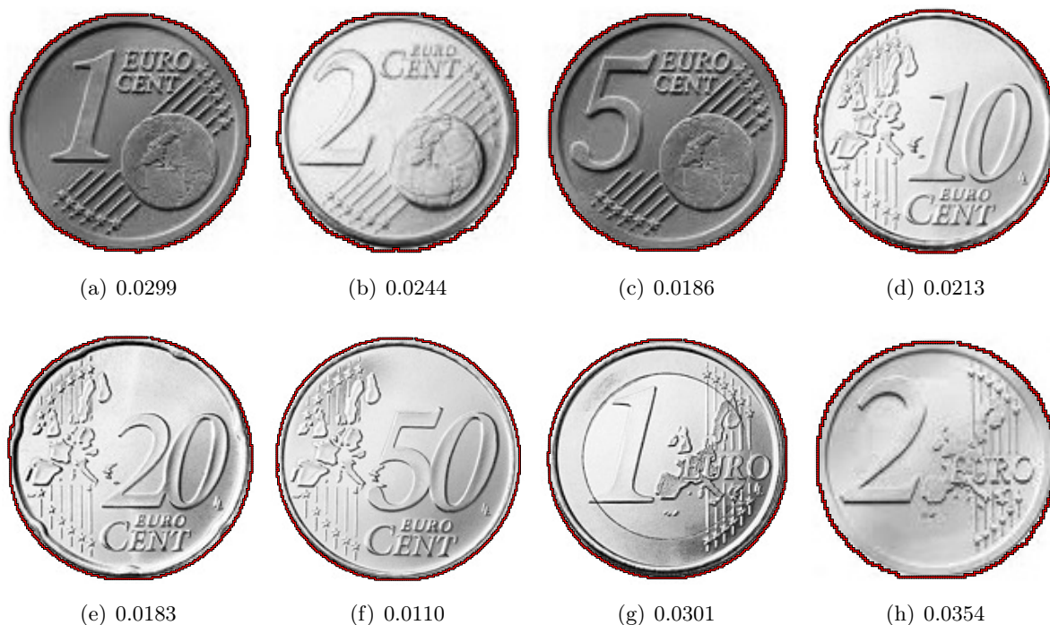
FIGURE 4.45 – La segmentation de contours des images dans la figure 4.44 et le résultat de mesure de circularité qui est obtenu par notre méthode.
