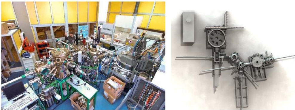
FIG. A.1 – À gauche, photo du complexe d'élaboration MPGA ; à droite, schéma du même montage vu du dessus.
