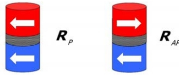
FIG. 1.9 – Schéma de principe d'une jonction tunnel magnétique. Les flèches schématisent la direction et le sens de l'aimantation des électrodes magnétiques. Définition des configurations parallèle (P) et antiparallèle (AP)
