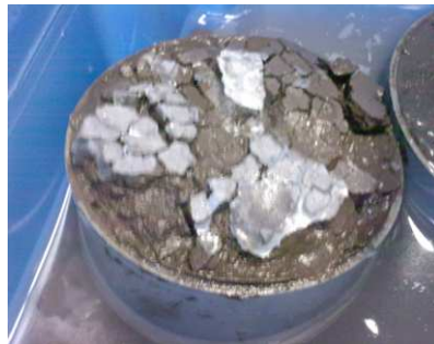
Figure III. 24 - Gonflement des poudres éteintes conservées sous eau
