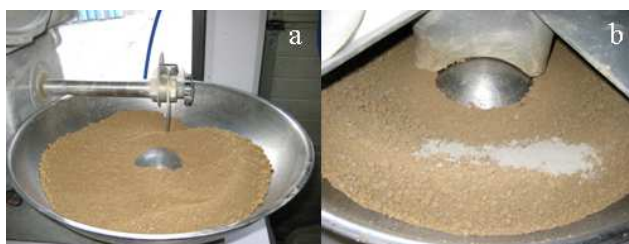
Figure V. 1 - Traitement de sol au laboratoire : (a) pré-traitement à la chaux ; (b) traitement au liant hydraulique routier
