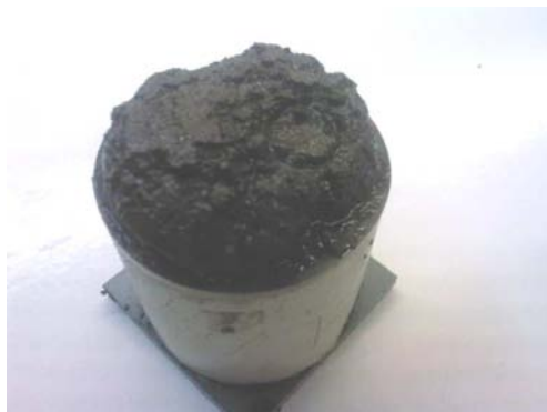
Figure III. 22 - Gonflement des pâtes hydratées sous eau
