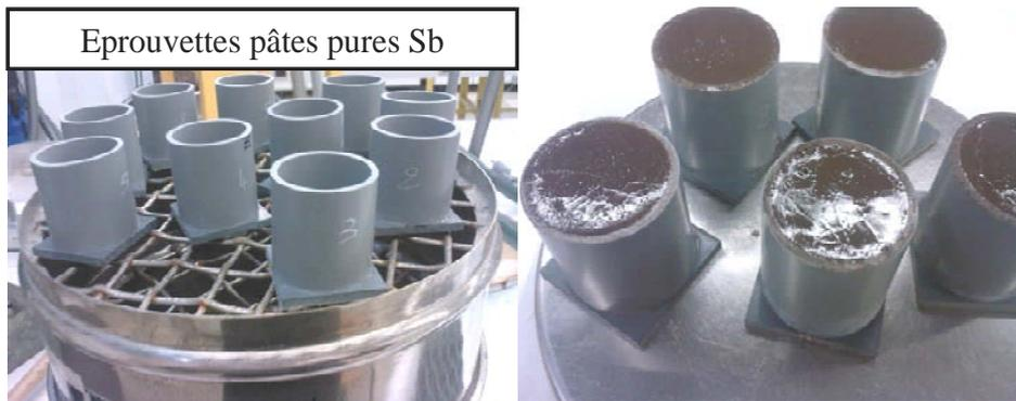
Figure III. 9 - Eprouvettes utilisées pour l'étude de l'hydratation des laitiers d'aciérie
