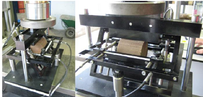
Figure V. 5 - Essai de traction indirecte
