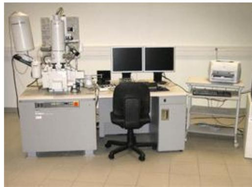
**Photo II.5 - MEB PHILIPS XL30 et MEB FEG HITACHI S-4800**
