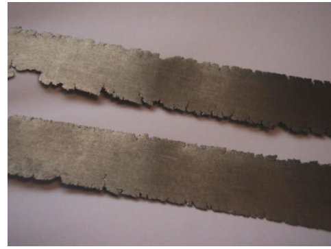
Photo III.1- Barreau de Gd_{60}Tb_{40} coulé à la lingotière et lamelles obtenues après laminage
