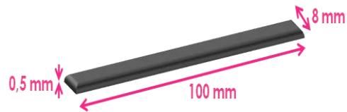
**Photo III.2 – Lamelle de  $Gd_{60}Tb_{40}$  après finition**
