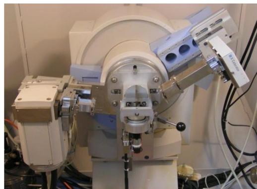
Photo II.3 - Diffractomètre Philips X'pert Pro
