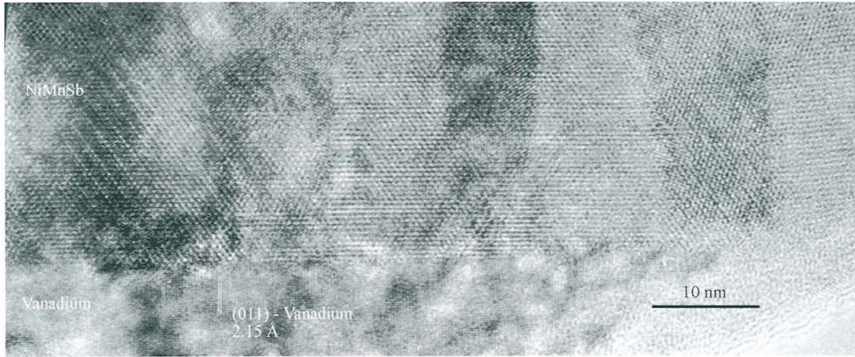
Figure 2.24 : Image de microscopie électronique haute résolution en coupe transverse d'une couche de NiMnSb(001) épitaxiée à température ambiante sur une couche tampon de vanadium (001).
