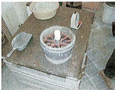
**Figure III.14 et III.15 :** Rhéomètre BT Rhéom
