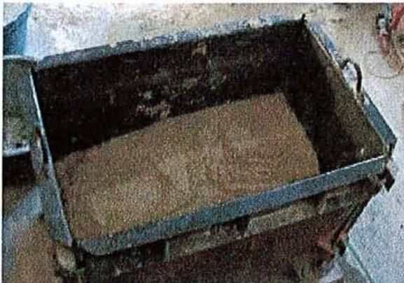
**Figure III.6** : Coffrage monté
