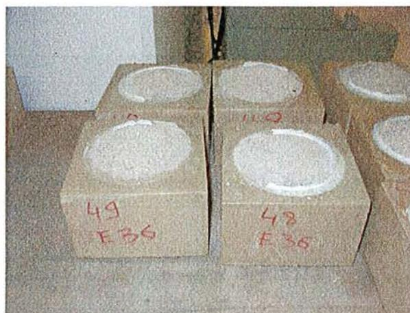
**Figure IV.38** : Blocs de pierres reconstituées par désaérage-essorage au terme de 25 cycles de gel-dégel en présence d’une solution saline NaCl dosé à 3 % en masse.
