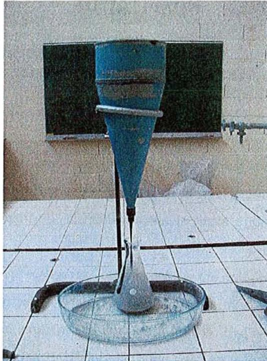
**Figure III.8 :** Mesure d'écoulement au cône de Marsh
