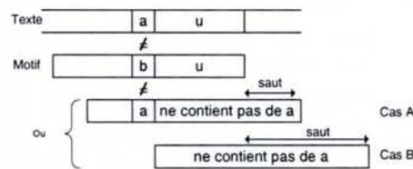
FIG. 5.4 – Heuristique du mauvais caractère de Boyer Moore
