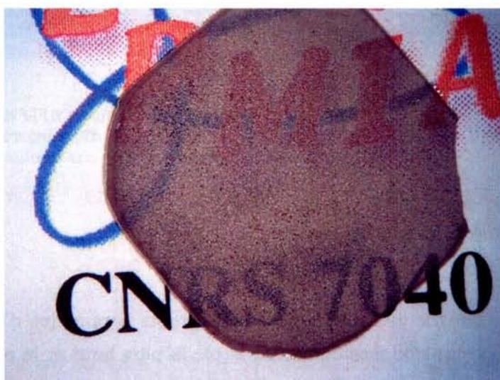
Figure V-15 : Films transparent autosupporté (épaisseur  $125 \mu\text{m}$ ) réalisé au laboratoire LPMIA.
