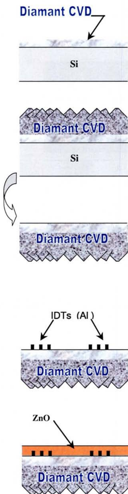
Figure V-18 : Etapes de réalisation d'un filtre SAW à base de diamant autosupporté
