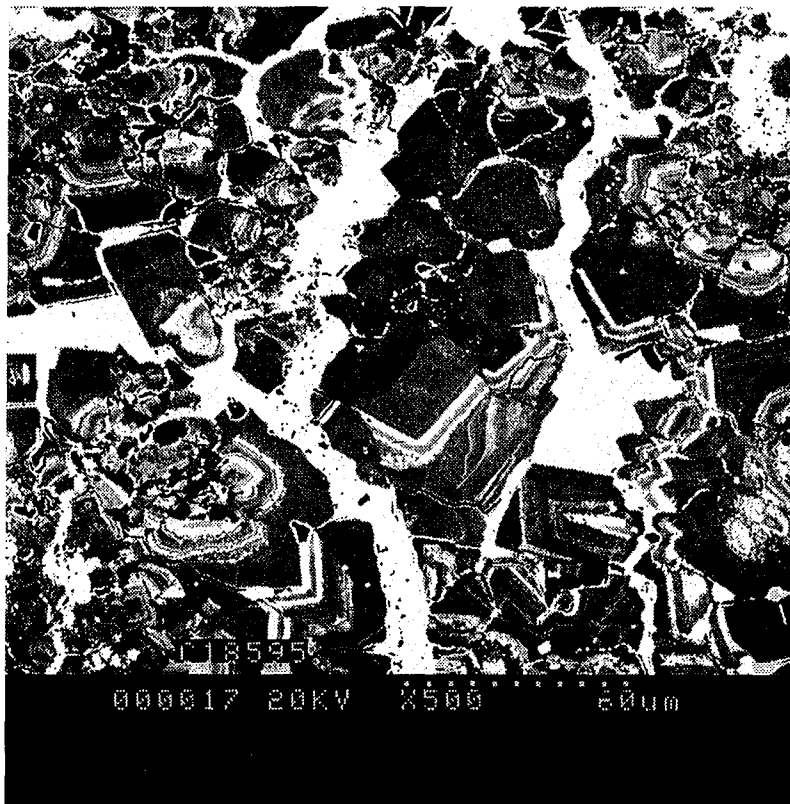
Planche D : Observation au MEB : Sulfures tardifs s'insinuant préférentiellement le long des bandes de surcroissances de la Pyrite.
