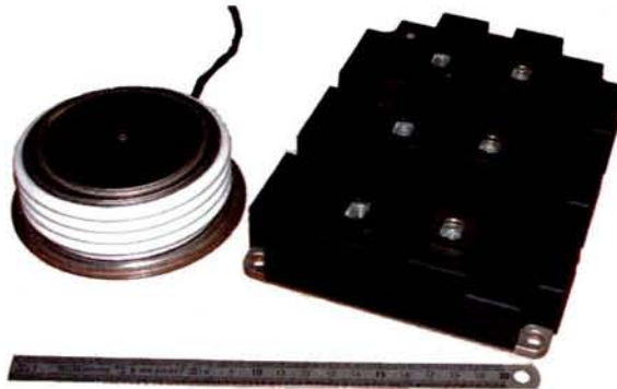
Fig.3: Boîtier pressé de Thyristor (gauche) et boîtier moulé d'IGBT
