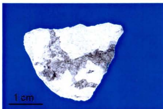
Echantillon de calcaire argileux fin prélevé dans la plate-forme oxfordienne du puits MSE 101 (469,5 m). Les traces noires proviennent de matériaux remplissant le stylolites.
