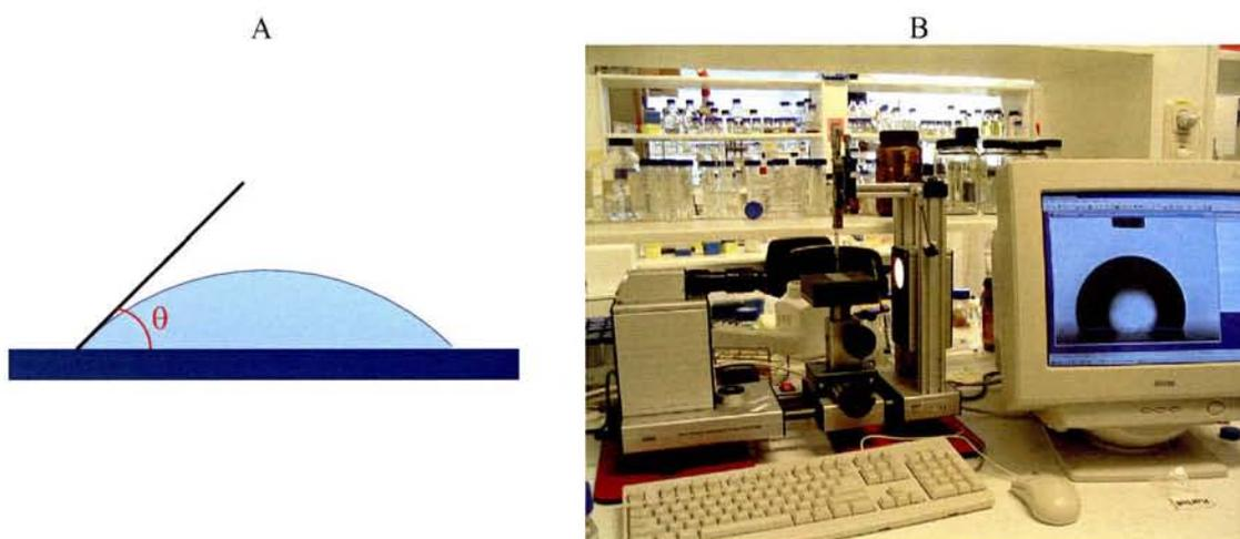
**Figure 14.** (A) Représentation d'une surface hydrophile mouillée par une goutte d'eau :  $\theta < 90^\circ$ . (B) Dispositif expérimental de mesure des angles de contact.
