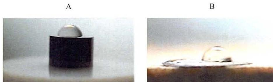
**Figure 48.** Mesure d'angle de contact sur surfaces de carbone (A) vitreux :  $88,7^\circ \pm 3,4$  et (B) amorphe :  $87,8^\circ \pm 4,2$ .
