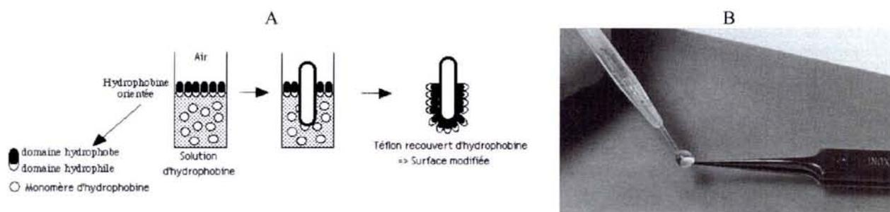
**Figure 20.** Schéma représentant les conditions expérimentales permettant l'auto-assemblage de l'hydrophobine sur (A) une surface en Téflon<sup>®</sup> d'après Tagu et Rogalska<sup>64</sup> et (B) une grille de carbone.
