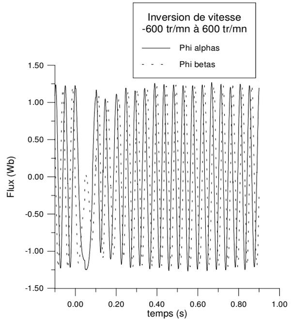
Figure 5.32 Flux  $\varphi_{\alpha s}$  et  $\varphi_{\beta s}$
