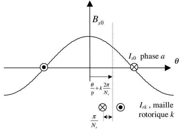
Figure 4.3 Position de la maille rotorique  $k$ , par rapport à la bobine statorique de la phase ( $m=0$ )
