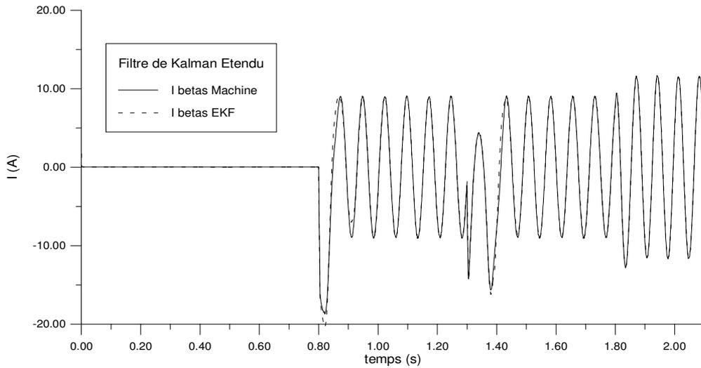
Figure 5.8 Evolution du courant statorique ( composante beta )
