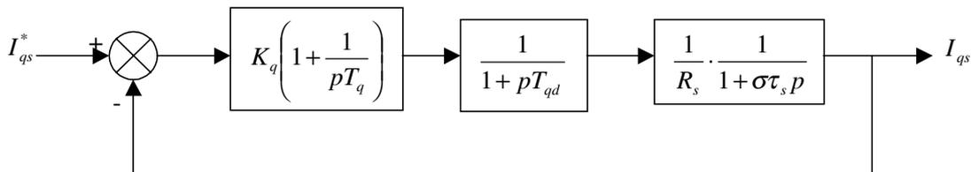
Figure 2.30 Boucle de régulation du courant  $I_{qs}$
