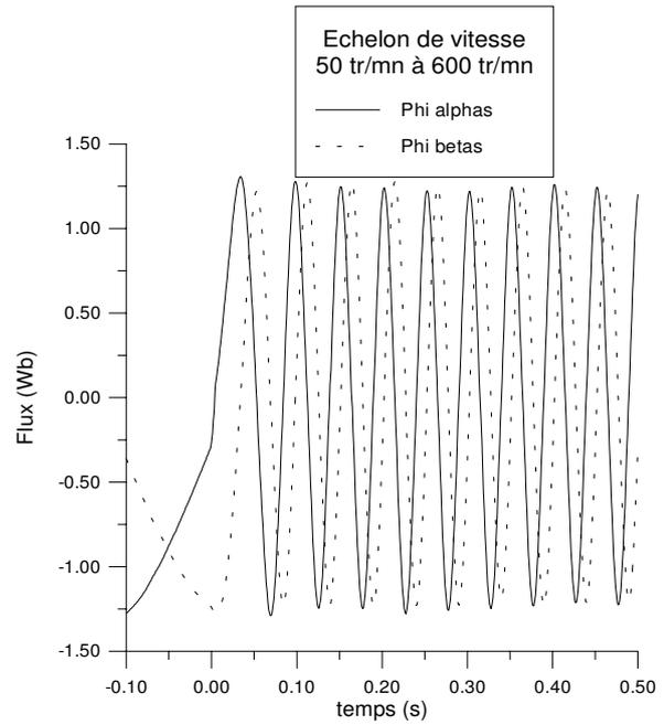
Figure 5.24 Flux  $\varphi_{\alpha s}$  et  $\varphi_{\beta s}$ , IRFO
