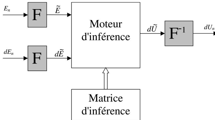
Figure 1.8 Structure du régulateur flou
