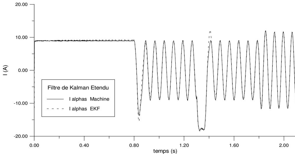
Figure 5.7 Evolution du courant statorique ( composante alpha )
