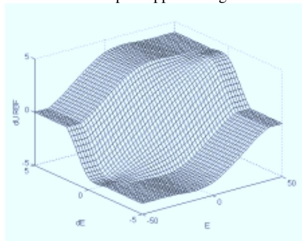
Figure 2.82 Surface réelle du régulateur neuronal RBF
