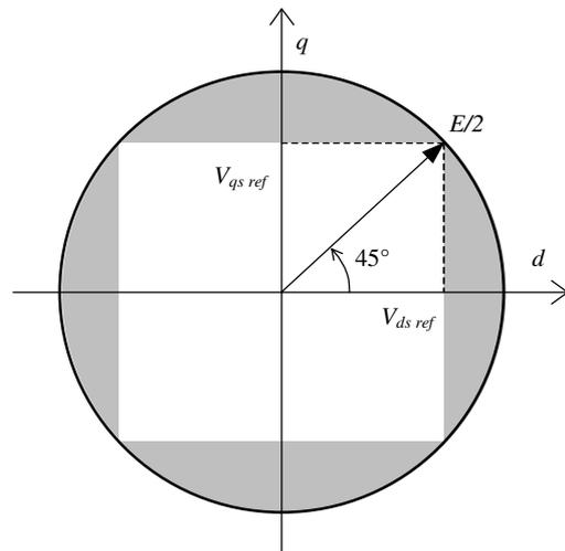
Figure A.5 Limitation de la sortie des régulateurs de courant
