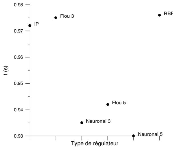
Figure 4.21 Temps de montée de 0 à 1000 tr/mn
