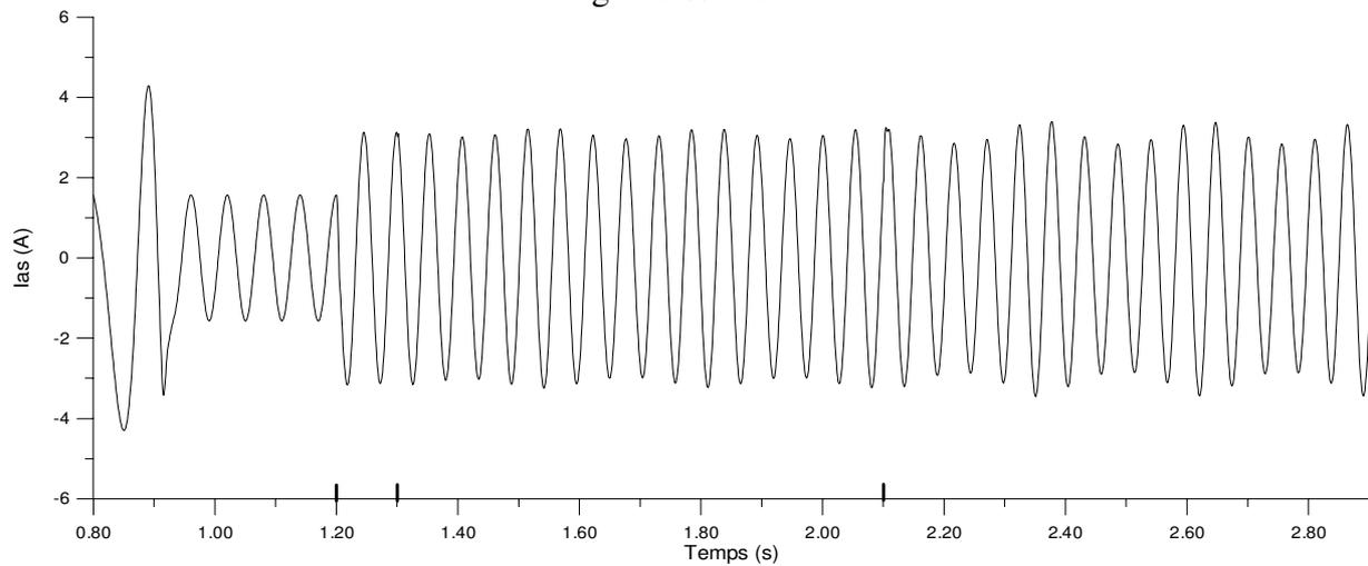
Figure 4.18 Courant  $I_{as}$  lors du changement de vitesse de référence à 1000 tr/mn puis en charge puis lors de la rupture de barres
