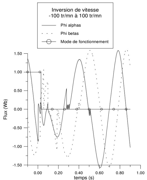
Figure 5.36 Flux  $\varphi_{\alpha s}$  et  $\varphi_{\beta s}$
