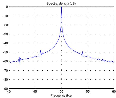
Figure 4.9 Moteur sain, expérimentation
