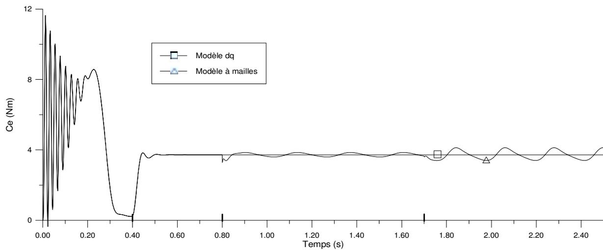
Figure 4.6 Couple au démarrage, en charge puis lors de la rupture de barres
