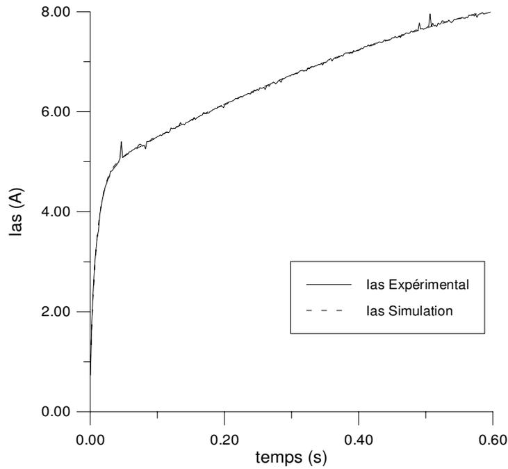
Figure 2.23 Identification par algorithme génétique sur une croissance du courant, Cas d'une alimentation par un onduleur à MLI
