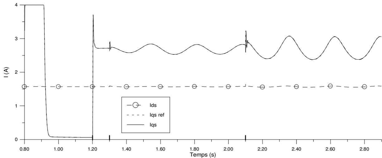
Figure 4.19 Courants de commande  $I_{ds}$ ,  $I_{qs\ ref}$  et  $I_{qs}$ , vitesse de référence à 1000 tr/mn puis en charge puis lors de la rupture de barres
