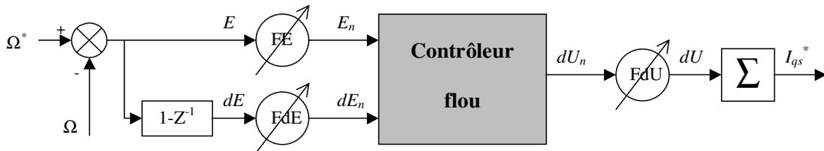
Figure 1.7 Schéma synoptique d'un régulateur flou de vitesse
