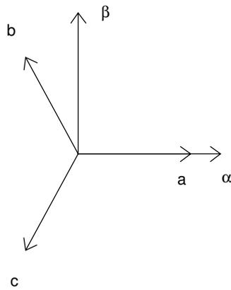
Il apparaît clairement ensuite que les repères de la transformation de Park des grandeurs statoriques et celle des grandeurs rotoriques doivent coïncider pour simplifier les équations. Ceci se fait en liant les angles  $\theta_s$  et  $\theta_r$  par la relation :
