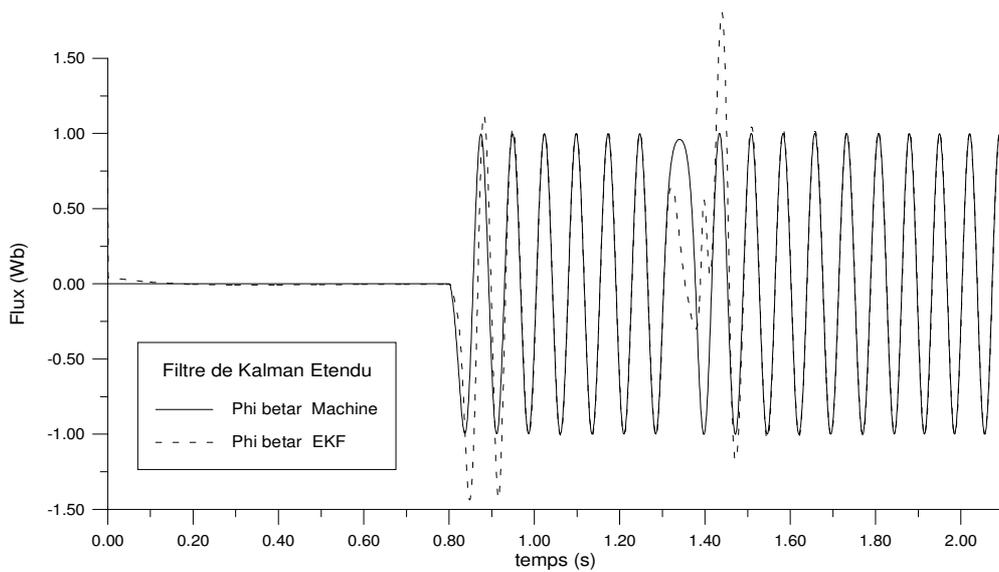
Figure 5.10 Evolution du flux rotorique ( composante beta )
