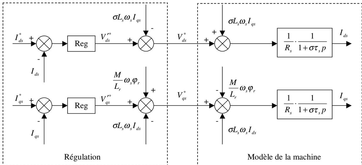
Figure 2.28 Découplage par addition des termes de compensation
