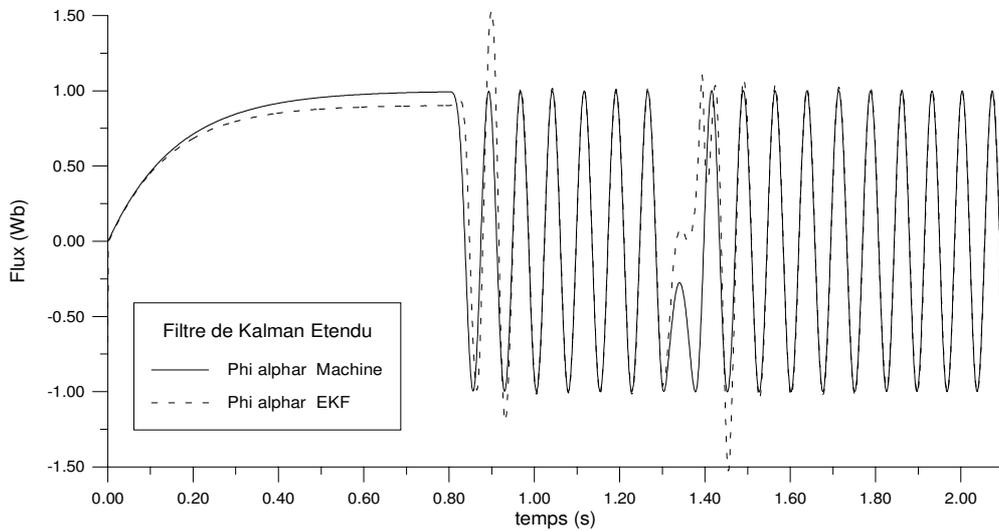
Figure 5.9 Evolution du flux rotorique ( composante alpha )
