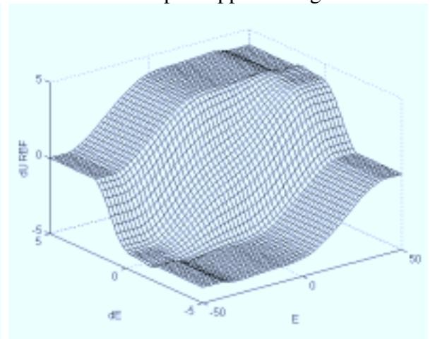
Figure 2.78 Surface réelle du régulateur neuronal RBF
