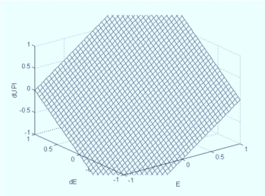
Figure 2.53 Surface caractéristique du régulateur PI
