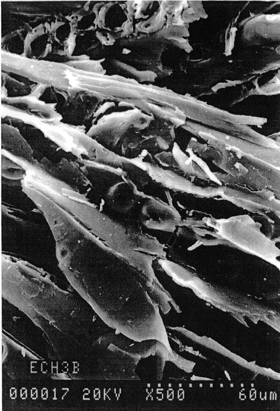
Figure 31 : cliché au MEB de la sciure greffée après lavage (gain de masse de 28 %).
