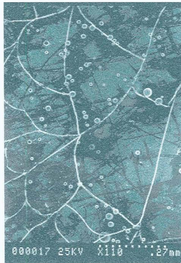
Figure V.3.3.4. : Dépôt de particules métalliques, grossissement : \times 110
