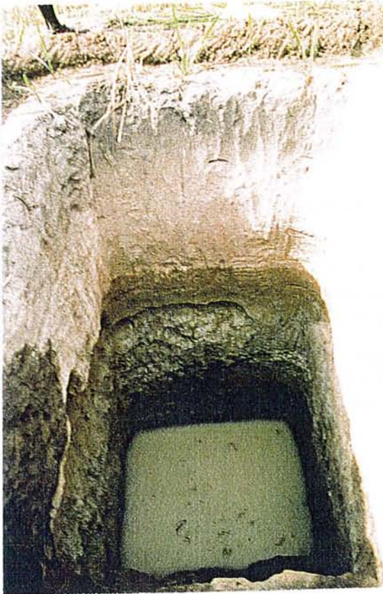
Photo 5 Site B. Infiltration de l'eau de pluie à travers les sols sableux du bas de versant contribuant à l'alimentation et au fonctionnement de la nappe perchée. Les horizon blancs sous l'horizon A1 sont encore secs. Remarquer l'Horizon Vert pistache argileux et compact en dessous des horizons A2 sableux blanchis des sols gris. Entre les deux horizons la cavité a été créée par l'écoulement de la nappe après le creusement de la fosse.
