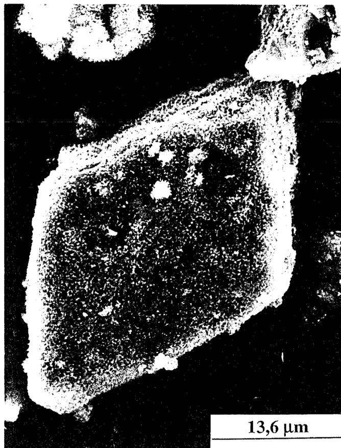
De 3 à 365 jours, l'échantillon présente des fissures montrant probablement que le taux de carbonate de calcium introduit initialement est trop important.
