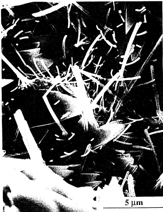
**PHOTO N°31** : Affinités chimiques  $C_6\overline{A}\overline{S}_3H_{32}$
