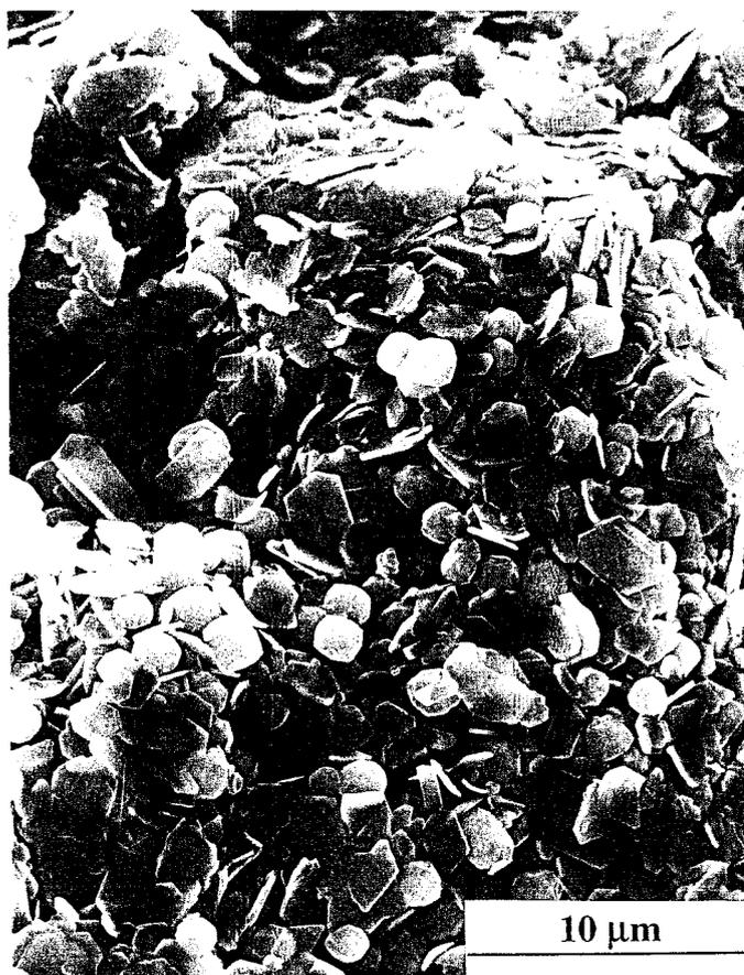
**PHOTO N°16** :  $C_3AH_6$  cubique et  $C_4\bar{A}CH_{11}$
