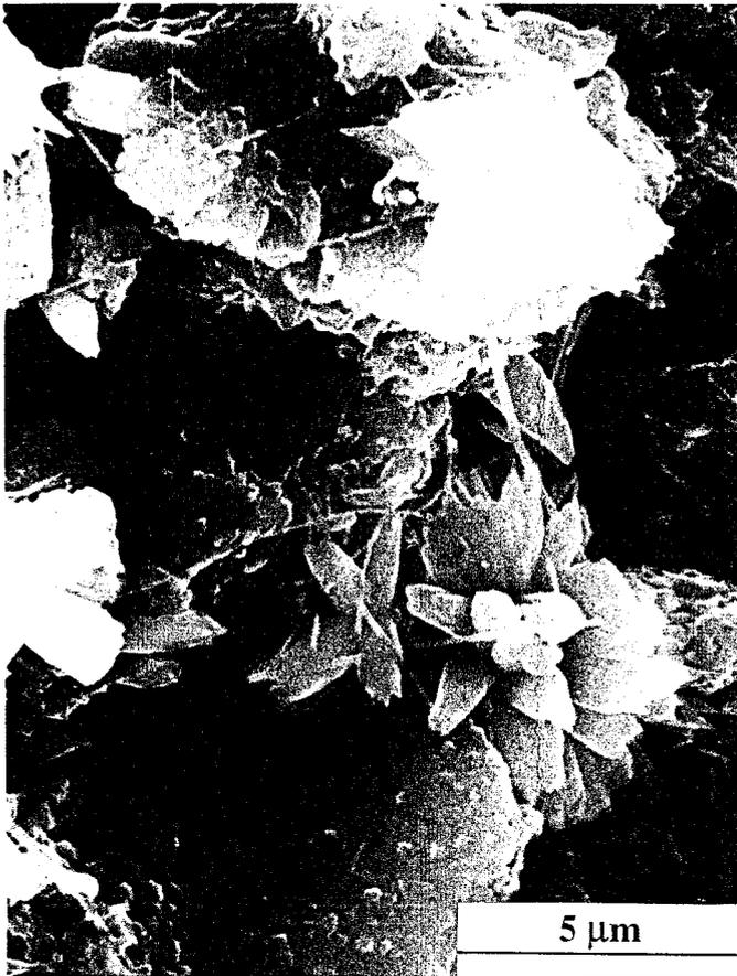
**PHOTO N°27** : Carbonatation de l'échantillon
