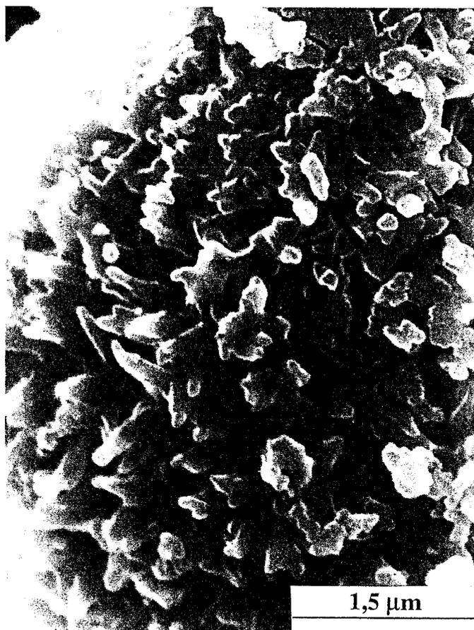
A 3 jours, le silicate calcique hydraté change d'aspect puisqu'il est maintenant constitué de filaments comme dans le cas de  $C_3S$  seul. Par contre, les affinités carbonate de calcium -  $C_xS_yH_z$  sont manifestes puisque nous observons des cristaux de calcite "corrodés" par le "gel CSH" l'ensemble formant un tout intimement lié (photo n°6) ; cette réaction se poursuit toujours de 90 à 365 jours.
