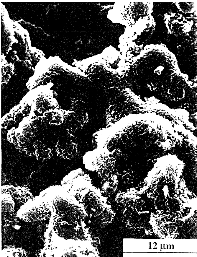
PHOTO N°26 : C_xS_yA_tH_z ( C_3S-C_3A-15\% \overline{CC} 3 j MC)
