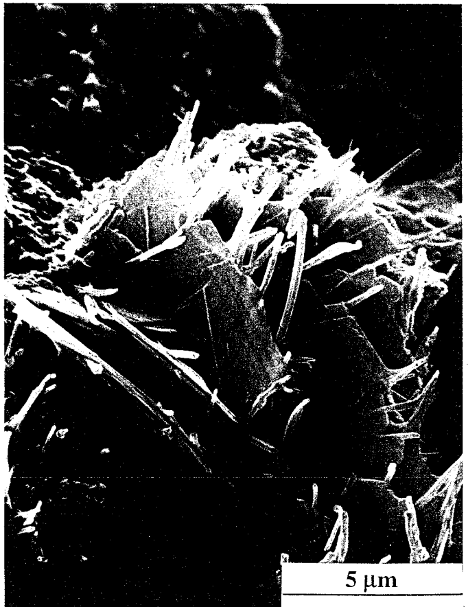
PHOTO N°34 : Complexe \text{C}_6\text{A}\bar{\text{S}}_3\text{H}_{32} -CH ( \text{C}_3\text{S} - \text{C}_3\text{A} -15% \text{C}\bar{\text{C}} -5% \text{C}\bar{\text{S}} 90 j MH)
