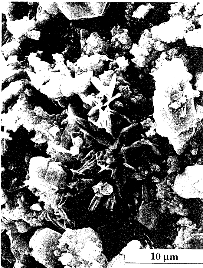
PHOTO N°35 : Carbonatation ( \text{C}_3\text{S} - \text{C}_3\text{A} -15% \text{C}\bar{\text{C}} -5% \text{C}\bar{\text{S}} 180 j MH)
