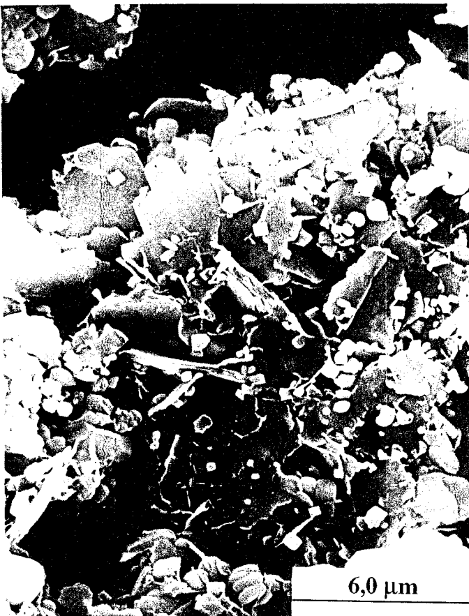
PHOTO N°18 : Aluminates calciques hydratés (C 3 A 1 j MH)
