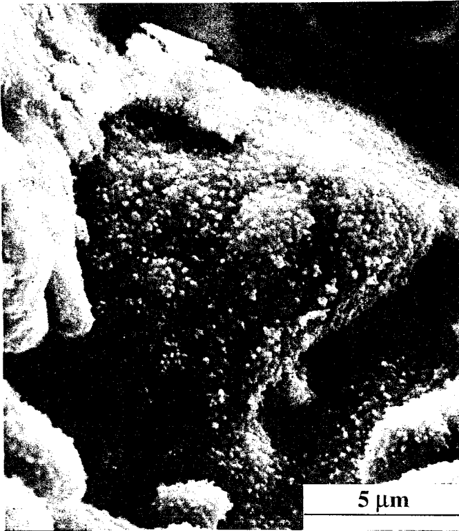
PHOTO N°5 : Incorporation de \text{CO}_3^{2-} dans \text{C}_x\text{S}_y\text{H}_z ( \text{C}_3\text{S} -5% \overline{\text{CC}} 1 j MC)
