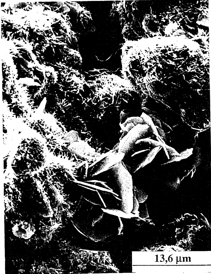
PHOTO N°29 : Affinités chimiques C_xS_yA_tH_z- C_6A\bar{S}_3H_{32} ( C_3S-C_3A-15\% C\bar{C} -5\% C\bar{S} 1 j MC)
