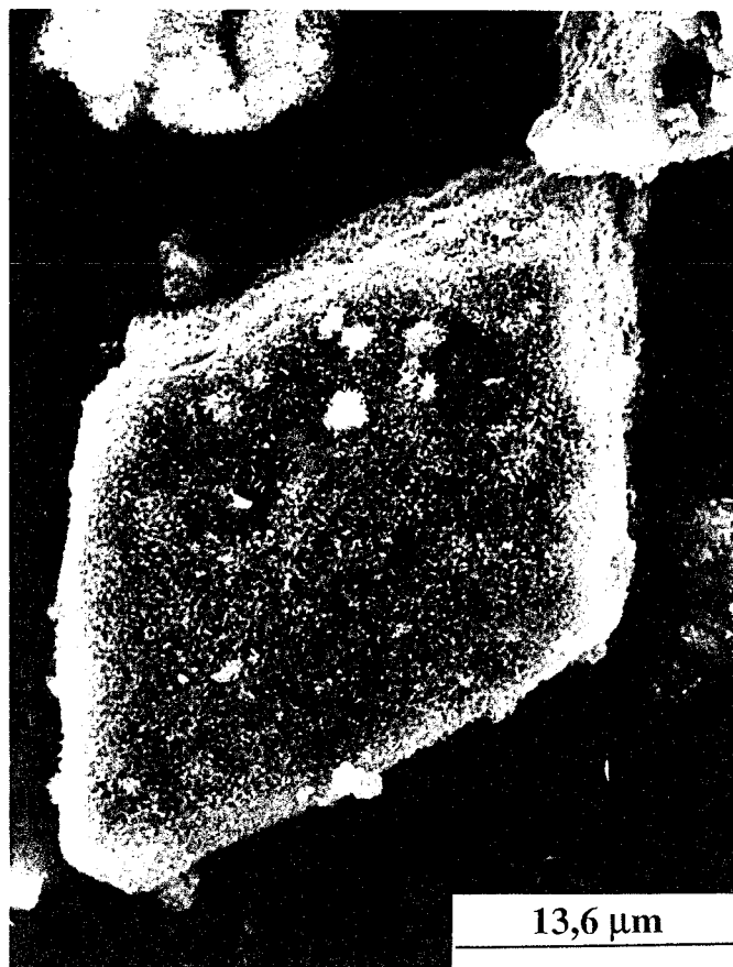
PHOTO N°11 : Rhomboèdre de \overline{CC} recouvert de C_xS_yH_z ( C_3S -50% \overline{CC} 90 j MC)
