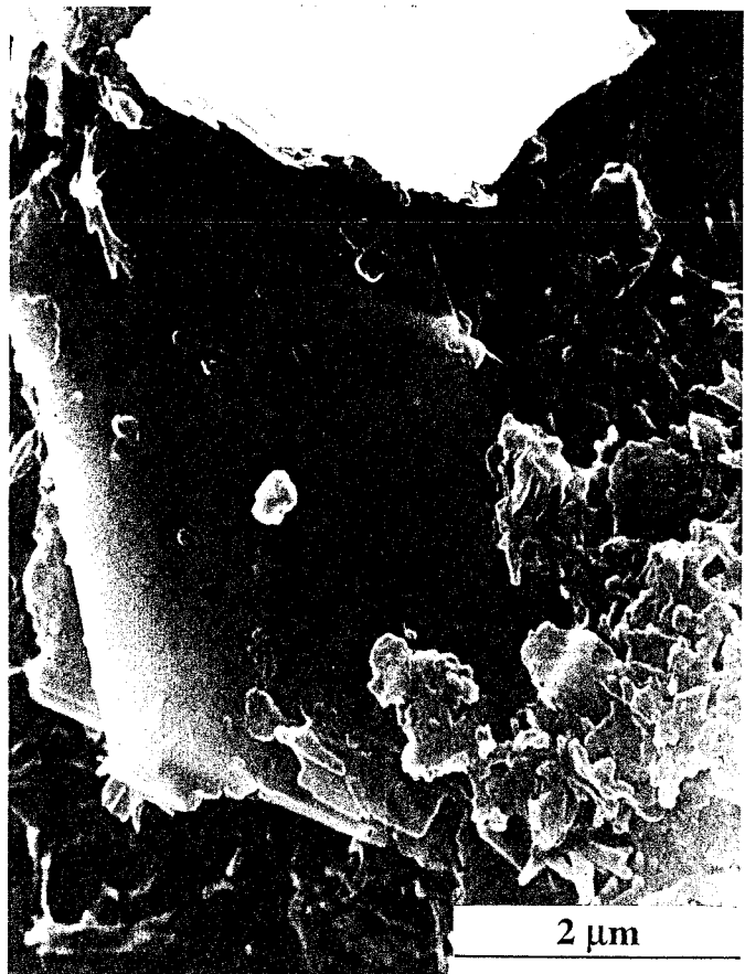
PHOTO N°28 : Plaquette hexagonale allongée selon \bar{a} (65) : C_4A\overline{CH}_{11} ( C_3S-C_3A-15\% \overline{CC} 28 j MH)
