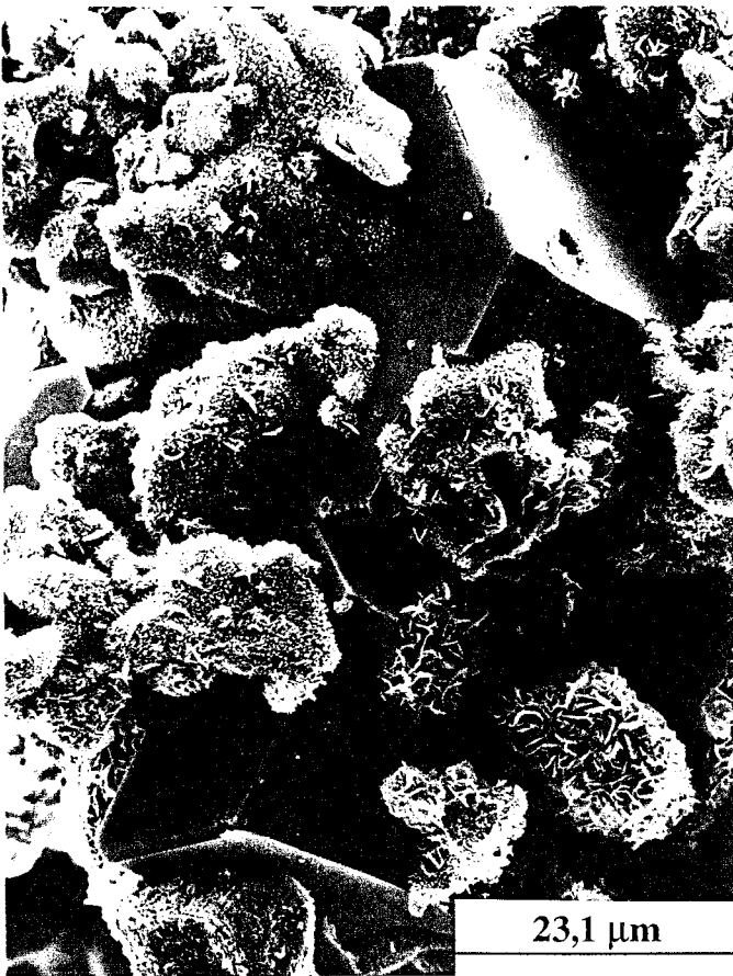
PHOTO N°25 : C_xS_yA_t\overline{C}_uH_z et probablement C_4AH_x ( C_3S-C_3A-15\% \overline{CC} 1 j MC)
