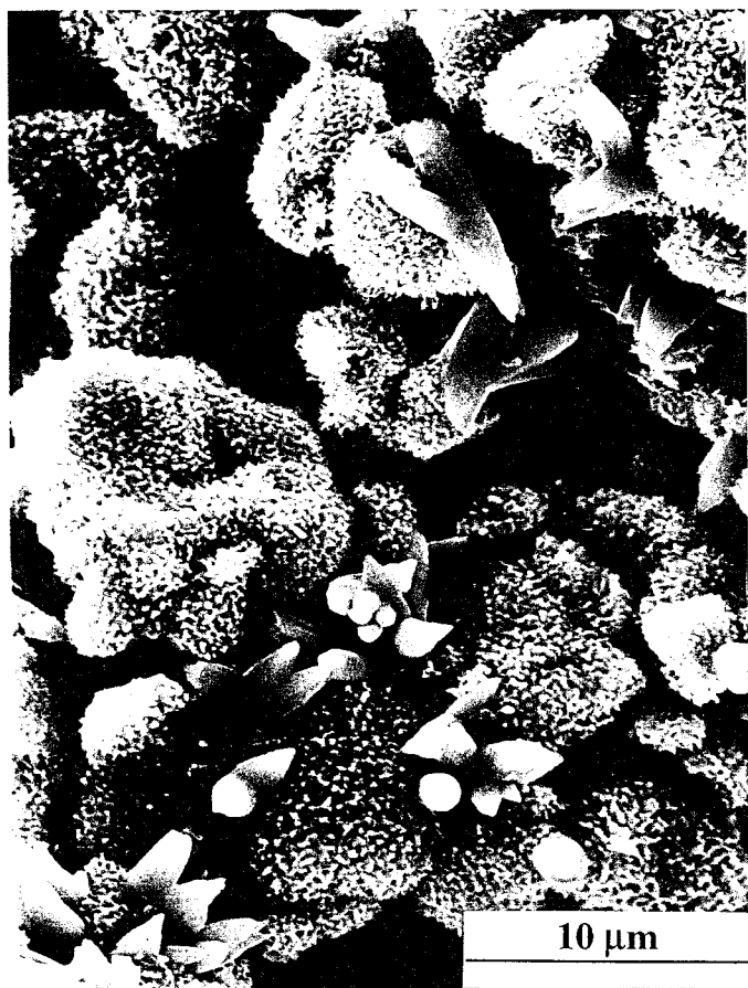
PHOTO N°10 : Carbonation de l'échantillon ( C_3S -15% \overline{CC} 180 j MC)
