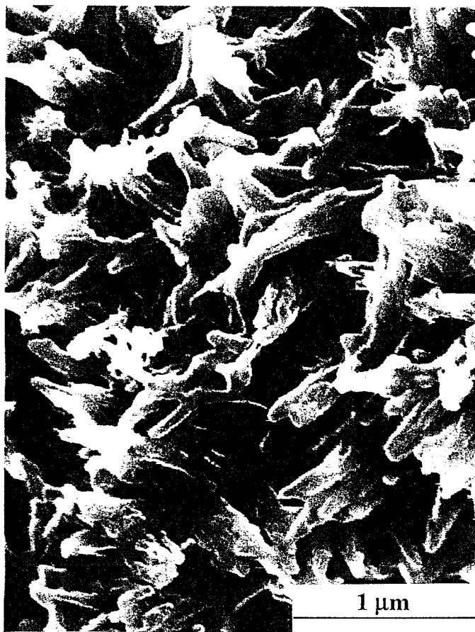
PHOTO N°3 : Filaments de C_xS_yH_z ( C_3S 90 j MC)
