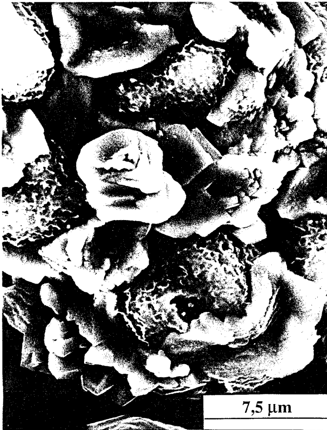
PHOTO N°14 : Carbonation de l'échantillon ( C_3S-15\% \bar{C}\bar{C} 28 j MH)
