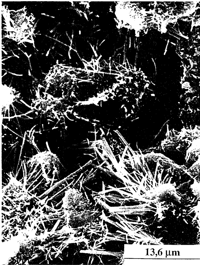
PHOTO N°33 : Affinités chimiques C_xS_yA_iH_z- C_6A\bar{S}_3H_{32} ( C_3S-C_3A-15\% C\bar{C}-5\% C\bar{S} 90 j MH)
