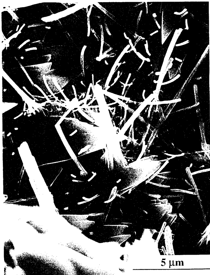
PHOTO N°31 : Affinités chimiques C_6\overline{A}\overline{S}_3H_{32} \overline{C}\overline{C} ( C_3S-C_3A-15\%\overline{C}\overline{C}-5\%\overline{C}\overline{S} 28 j MH)
