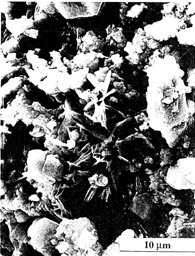
PHOTO N°35 : Carbonatation ( C_3S-C_3A-15\% C\bar{C}-5\% C\bar{S} 180 j MH)
