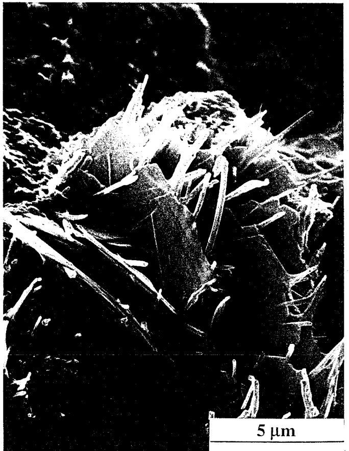
PHOTO N°34 : Complexe C_6A\bar{S}_3H_{32}-CH ( C_3S-C_3A-15\% C\bar{C}-5\% C\bar{S} 90 j MH)
