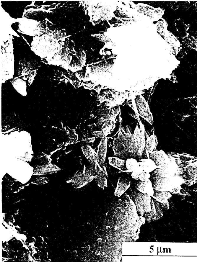
PHOTO N°27 : Carbonatation de l'échantillon ( C_3S-C_3A-15\% \overline{CC} 7 j MH)
