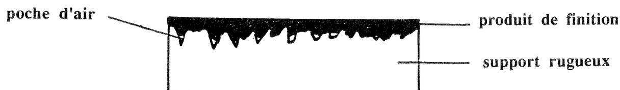
Figure 22 : Influence de la rugosité sur la pénétration de la finition (27)
