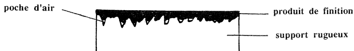
Figure 22 : Influence de la rugosité sur la pénétration de la finition (27)
