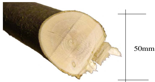
Figure 121 : Etat de surface d'une branche de 50mm de diamètre amenée à 0.5km/h et coupée à 800tr/min
