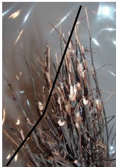
Figure 51 : Coupe en biseau due à la flexion de branches
