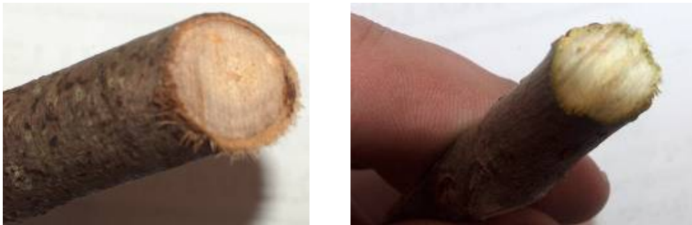
Figure 47 : Etat de surface obtenu sur les branches de diamètre 15mm
