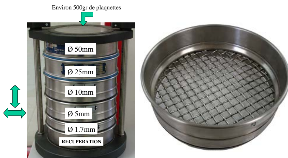
Figure 115 : Schéma d'une tamiseuse de laboratoire et d'un tamis de 10mm
