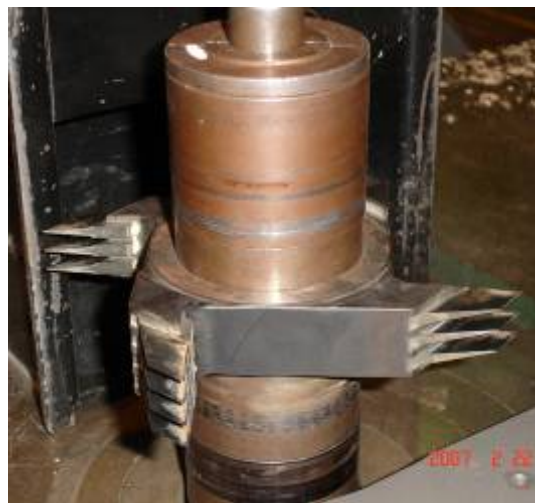
Figure 55 : Montage de l'outil à enturer sur l'arbre de la toupie d'essais
