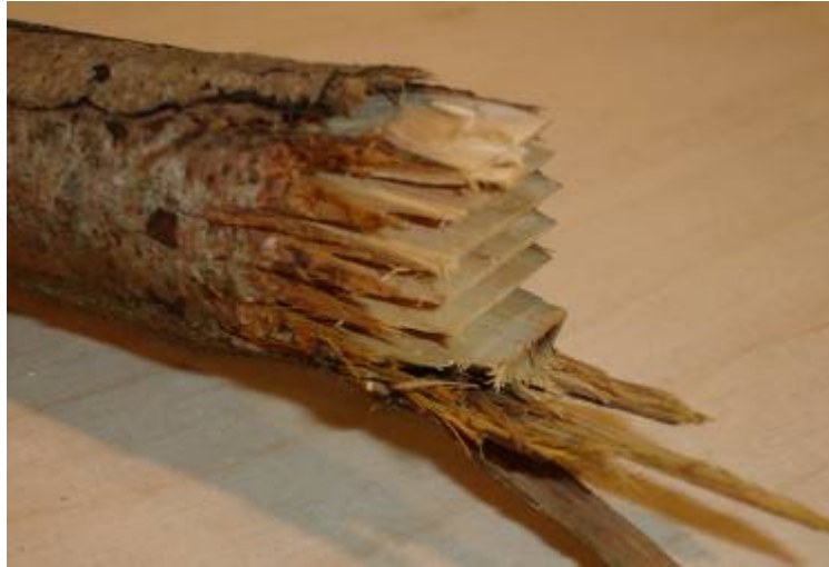
Figure 58 : Etat de surface d'une branche obtenue par l'outil à enturer
