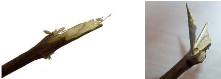
Figure 45 : Exemple d'éclatement avec des coupes de 8mm
