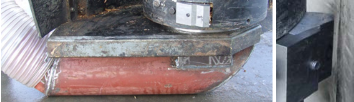
Figure 161 : A gauche, évacuation des copeaux par la partie basse, palier creux et tubage en coude et à droite, aménagement du fond de la carcasse
