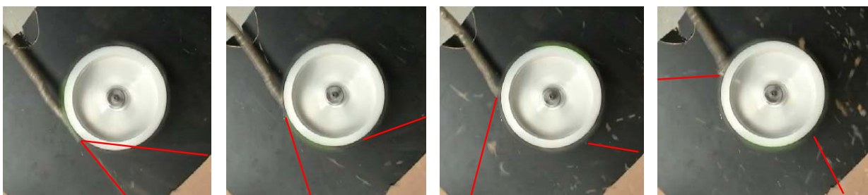
Figure 139 : Evolution de la projection des copeaux lors d'un usinage (ex : 800tr/min, 1km/h)
