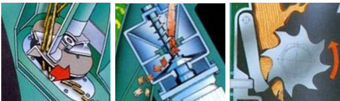
Figure 37 : De gauche à droite : Coupe par couteaux, par vis sans fin et par mono tambour
