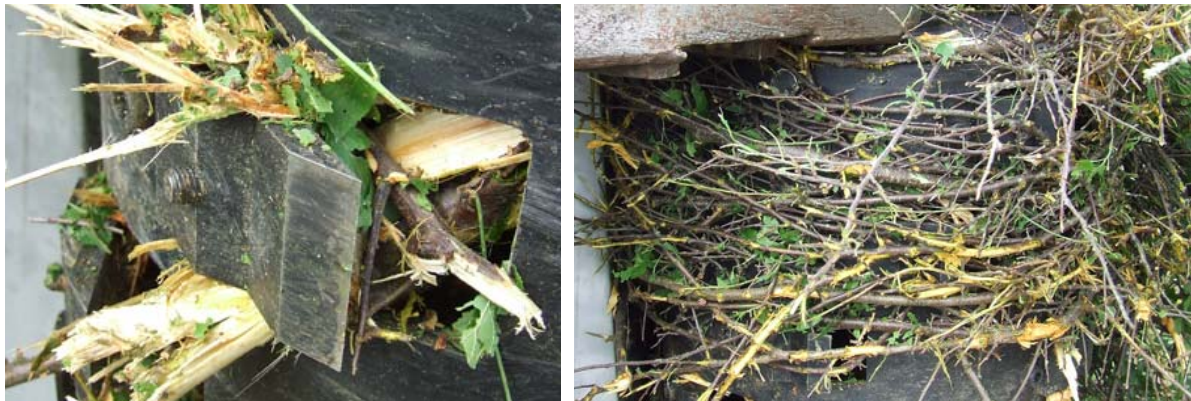
Figure 152 : Exemple de coinçage de branche entre le couteau et le corps d'outil et bourrage du rotor à cause de l'enroulement de branches pour 800tr/min
