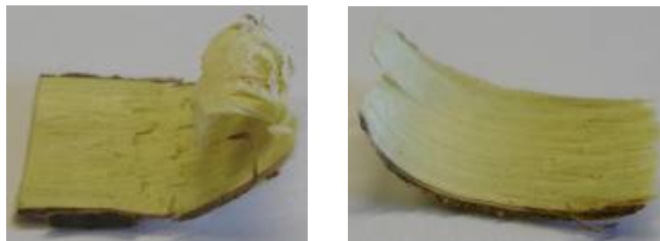
Figure 128 : Copeaux de TYPE I formé avec un angle de coupe de 55° (à gauche) et de TYPE II avec 25° (à droite)
