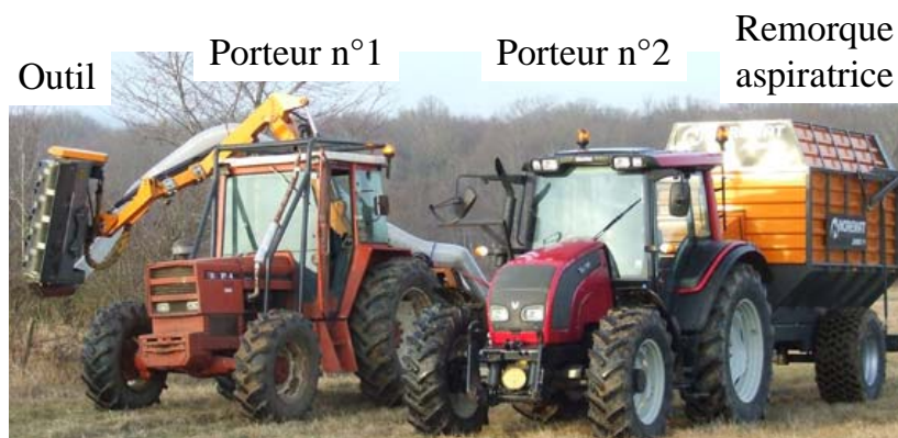
Figure 162 : Mise en place des deux porteurs, de l'outil et du système d'aspiration
