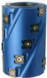
Figure 49 : Type d'outil utilisé pour simuler un rotor à couteau
