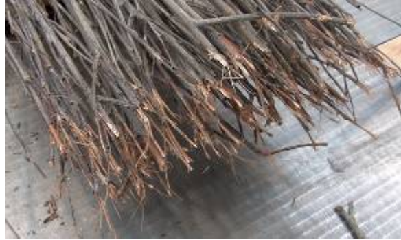
Figure 46 : Etat de surface de coupe d'un fagot de petits diamètres.
