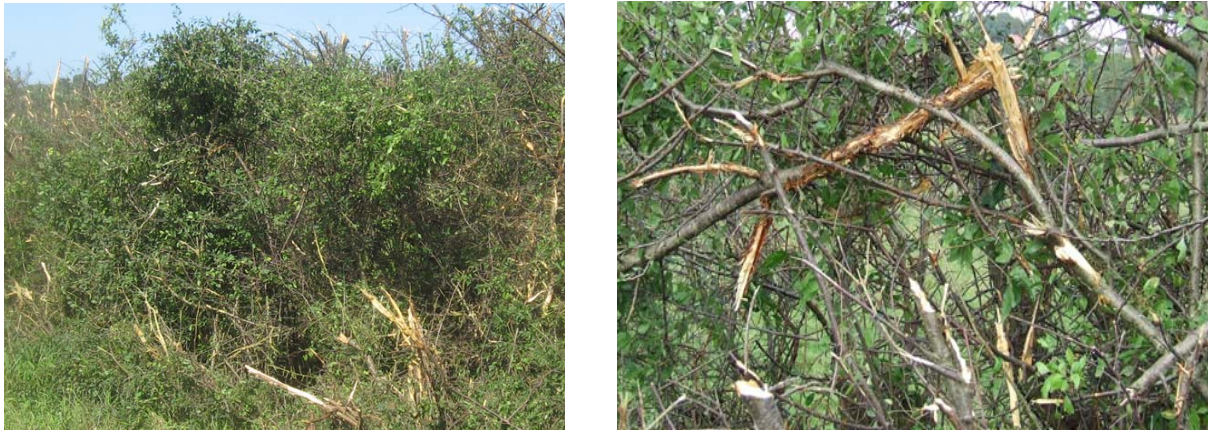
Figure 151 : Une partie de la haie une fois coupée par l'outil à 800 tr/min
