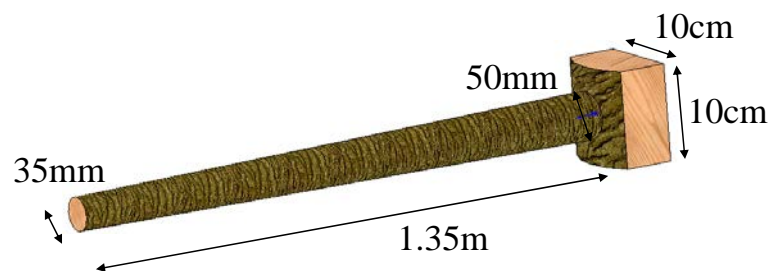
Figure 108 : Schéma de découpe d'une branche à l'usinage
