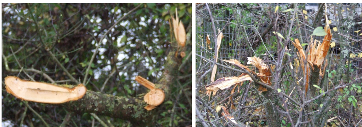
Figure 158 : à gauche coupe de branche avec les couteaux en U, à droite exemple de mauvais état de surface obtenu avec les couteaux élargis.
