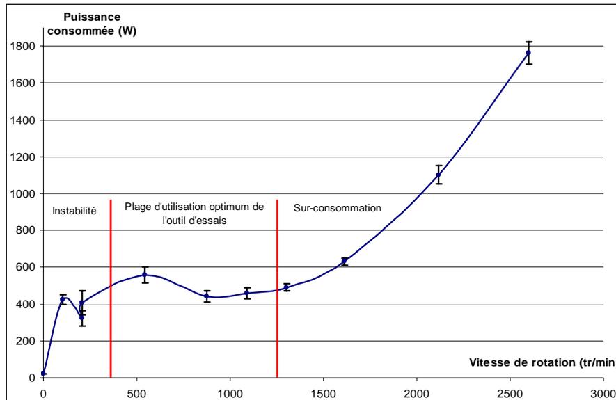
Figure 116 : Evolution de la puissance électrique consommée pour la rotation simple de l'outil
