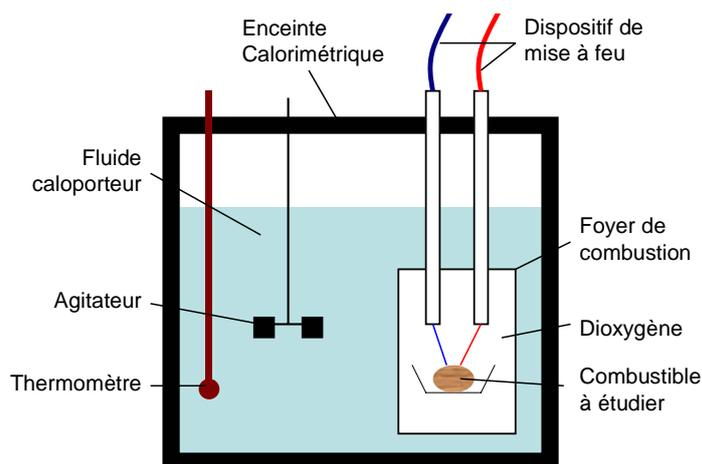
**Figure 31 : Schéma de fonctionnement d'une bombe calorimétrique**
