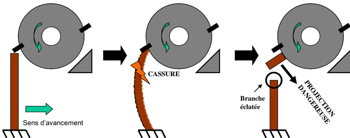
Figure 99 : Phénomènes de cassures liés à l'usinage en avalant
