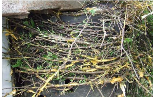
*Figure 152 : Exemple de coincage de branche entre le couteau et le corps d'outil et bourrage du rotor à cause de l'enroulement de branches pour 800tr/min*
