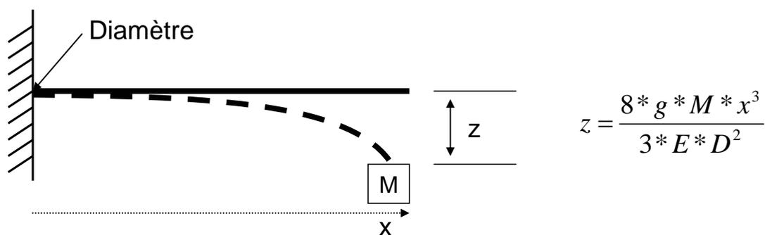
Figure 34 : Schéma de principe des essais de flexion et formules consacrées
