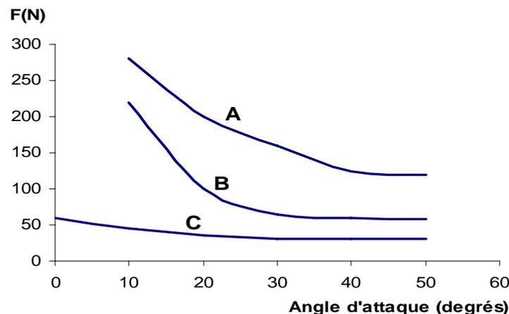
Figure 50 : Variation de l'effort de coupe suivant les modes A, B ou C pour du Hêtre à 12% d'humidité, copeau de 0.2mm d'épaisseur, outil usé à 50% [MARTIN ;38]
