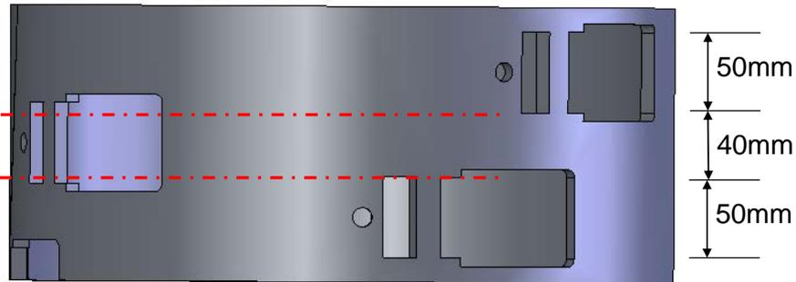
**Figure 143 : Recouvrement des zones de coupe**
