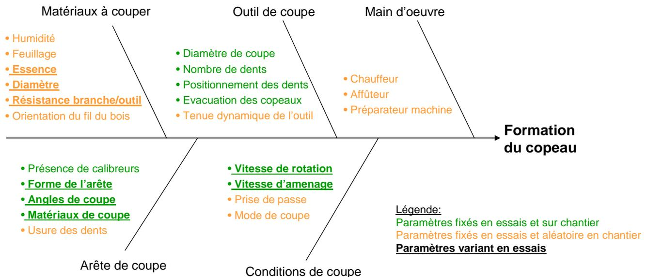
Figure 107 : Diagramme cause-effets de la formation des plaquettes
