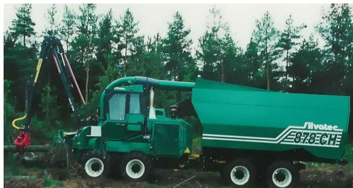
*Figure 27 : Déchiqueteuse automotrice SILVATEC*
