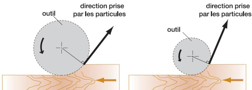
*Figure 103 : Variation de la direction de projection en fonction du diamètre d'outil (prise de passe constante)*
