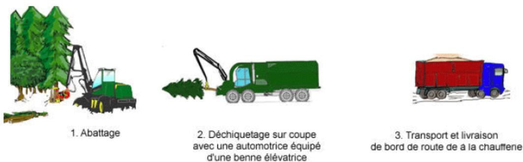
*Figure 18 : Production de plaquettes en forêt et flux direct*
