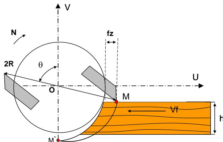
Figure 72 : Récapitulatif des paramètres de coupe influant sur la formation des plaquettes en déchiqetage par broyeurs à tambour
