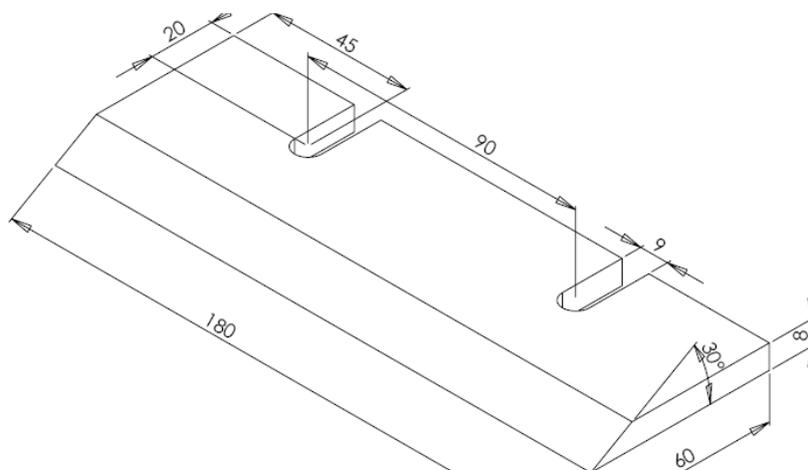
**Figure 91 : Schématisation des couteaux utilisés**
