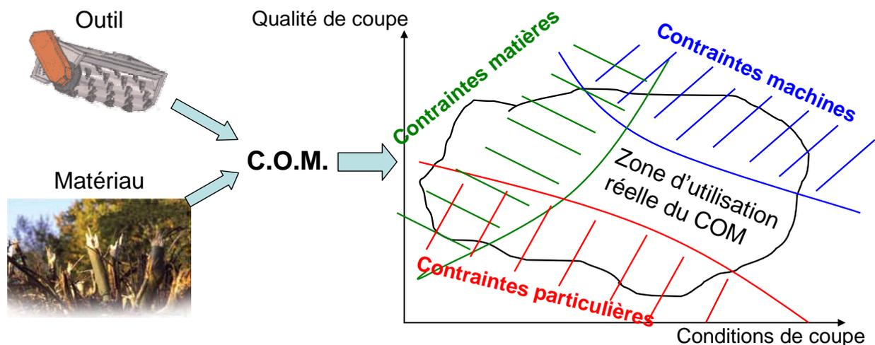
Figure 4 : Principe de fonctionnement du Couple {Outil-Matière} [adapté de NORME E66-520-1 ;6]
