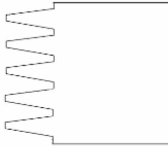
*Figure 54 : Profil d'une enture pour l'aboutage*
