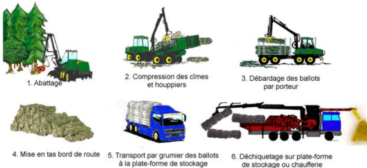
*Figure 21 : Production de plaquettes sur plate-forme à partir de houppiers compactés*
