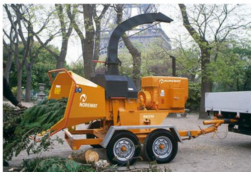
*Figure 25 : Broyeur de branche actionné par leur propre moteur*
