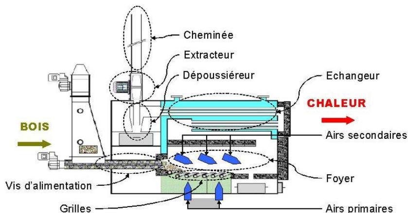
*Figure 15: Présentation générale d'une chaudière à bois automatique*
