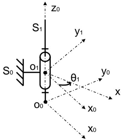
Figure 92 : Schéma cinématique de l'outil d'essais
