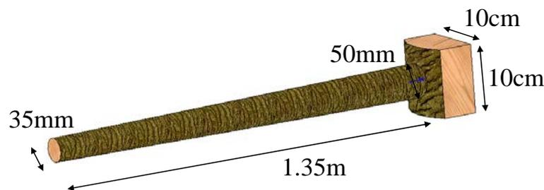
Figure 108 : Schéma de découpe d'une branche à l'usinage
