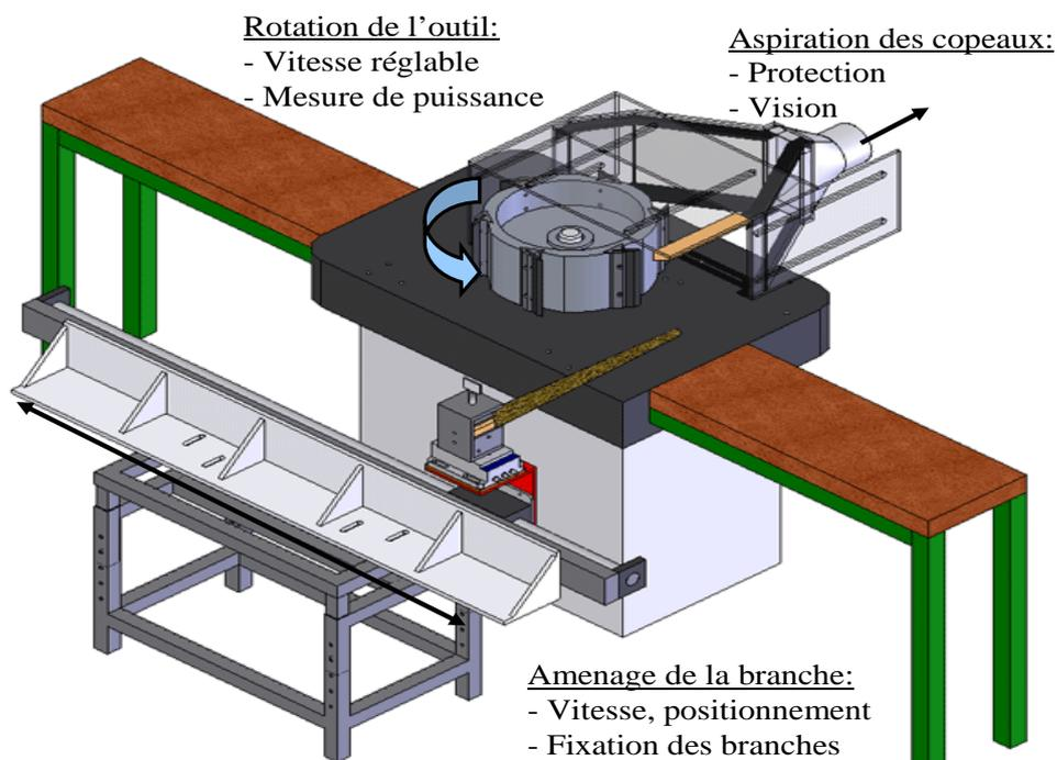
Figure 112 : Dessin CAO de la partie coupe du banc d'essais avec descriptif des différents organes présents.
