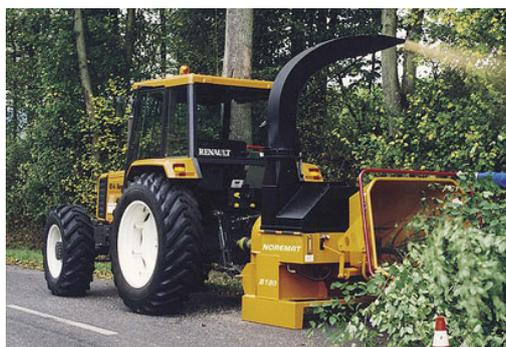
*Figure 24 : Broyeur de branche actionné par la prise de force d'un tracteur*
