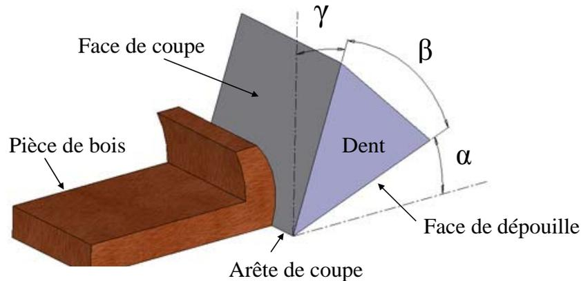
*Figure 51 : Définition des angles [NF E 66-502 et 504 ;42 et 43],
