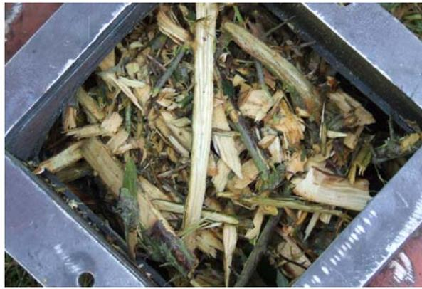
*Figure 165 : Ouverture du coude d'évacuation après coupe et démontage, grande tige qui bloquent tout*
