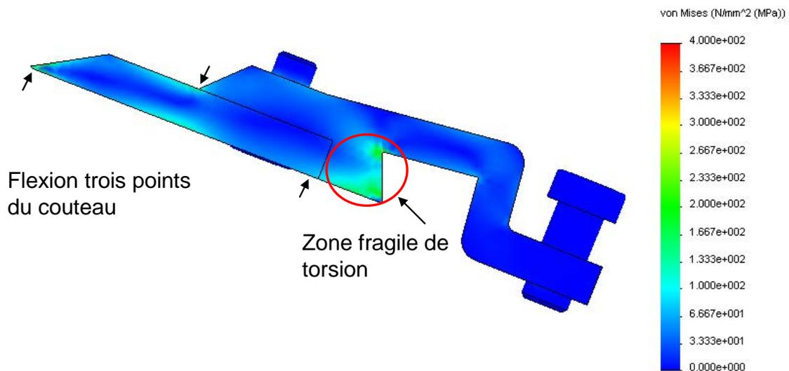
*Figure 147 : Contraintes résultantes dans l'ensemble {couteau+insert+vis}*
