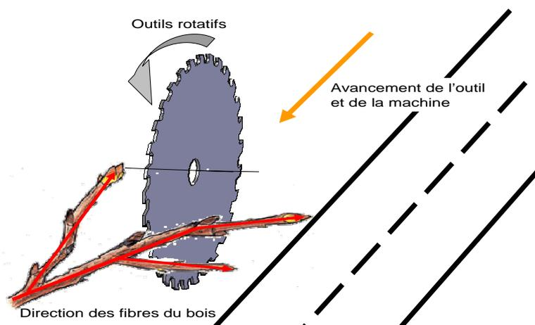
Figure 33 : Schématisation des conditions de coupe par lamier
