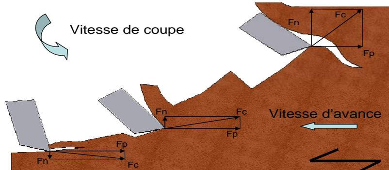
Figure 58 : Formation du copeau en coupe rotative en opposition adapté de BOUCHER [49]
