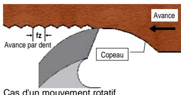
L'avance par dent permet de comparer les performances d'outils entre eux. Elles s'affranchie du nombre de dents, de la vitesse de rotation et de la vitesse d'avance. Plus l'avance par dent est faible, et plus la qualité d'usinage est importante. Elle est exprimée en mm.
