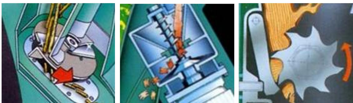
Figure 37 : De gauche à droite : Coupe par couteaux, par vis sans fin et par mono tambour
