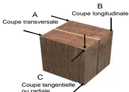
On prend pour hypothèse que la direction générale des branches à couper est horizontale et que les fibres de bois sont suivant cette direction. Dans le cas d'un tronçonnage de la branche (Coupe A) on vient trancher les fibres alors que dans le cas d'un rabotage (coupe B) les fibres sont séparées. Les conditions de coupe sont alors très différentes.
