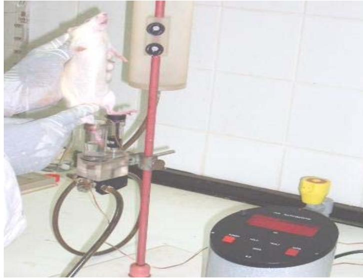
**Photo 30:** Pléthysmomètre électrique (model 7150 UGO BASILE, Italie)
