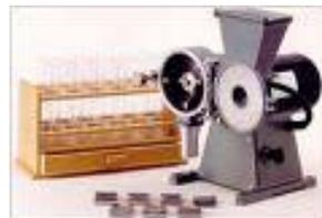
Broyage à travers un tamis 500  $\mu\text{m}$
