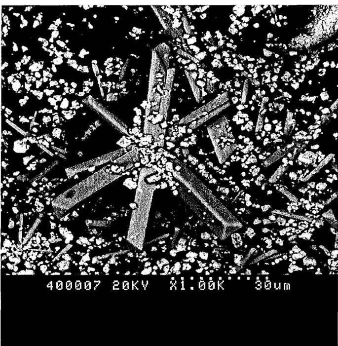
Figure 28 : Photos MEB d'un mélange  $\text{Cu}_2\text{O} + \text{SeO}_3^{2-}$  en électrons secondaires à gauche et en rétrodiffusés à droite.  $[\text{Cu}_2\text{O}] = 30 \text{ g/L}$ ,  $[\text{SeO}_3^{2-}] = 4 \cdot 10^{-3} \text{ M}$ ,  $[\text{H}^+]_{\text{initiale}} = 7 \cdot 10^{-4} \text{ M}$ , pH final = 8,5.
