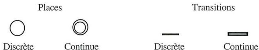
Figure 6.4 Nœuds d'un RdPH
