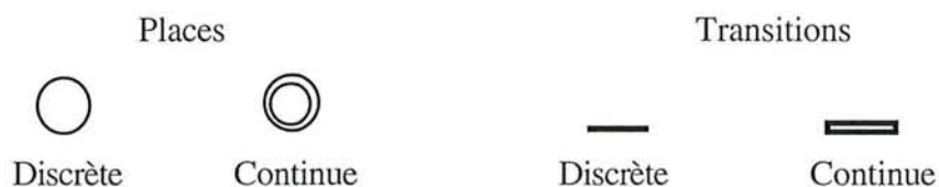
Figure 6.4 Nœuds d'un RdPH
