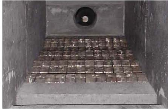
Figure 3-9 : Vue d'ensemble des grilles à l'intérieur du foyer.
