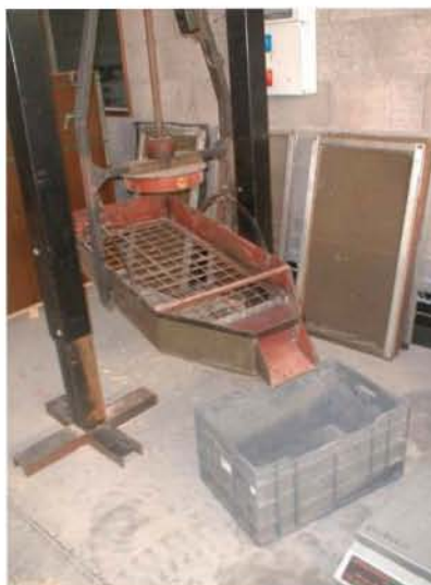
Figure 3-1 : Table de tri vibrante recevant les tamis de tri granulométrique (visible sur la photo le tamis de 63mm d'ouverture).
