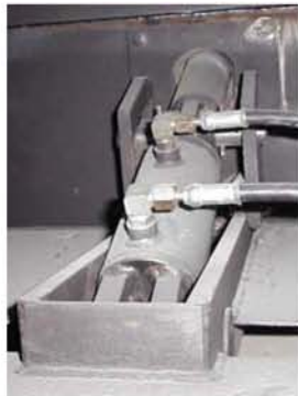
Figure 3-10 : Vue sous le foyer du mode de montage des éléments de grilles (à droite) et du vérin engendrant le déplacement (à gauche).
