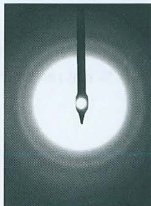
Figure 120 : Cliché de diffraction électronique d'un système "Ni 3 -Fe" après oxydation théorique de 10 % du fer
