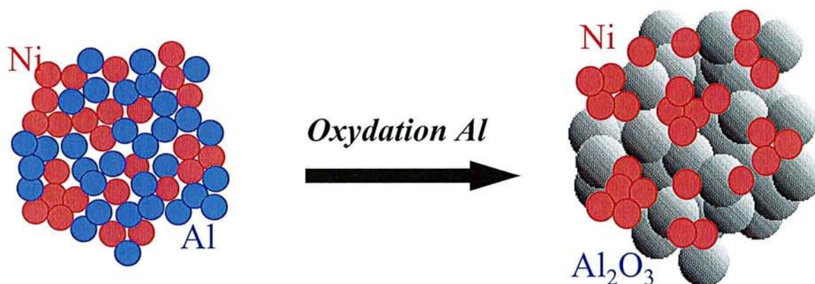
Figure 95 : Représentation schématique de la formation des particules d'un système "Ni-Al"
